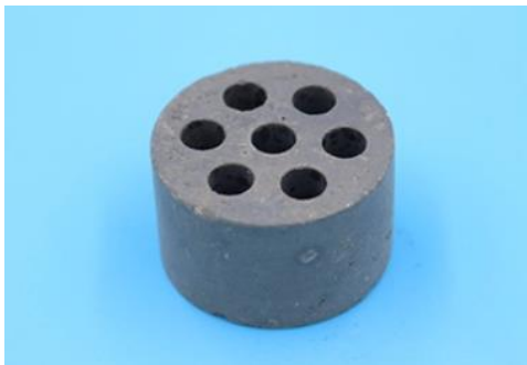
Figura 7-5. Catalizador de Ni- La soportados sobre γ-Al 2 O 3 . Fuente: Yixing Winner Technology Ltd.
