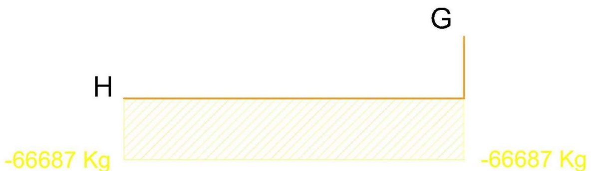
Figura 4.23. Diagrama de esfuerzo normal. Hipótesis I. Viga HG
