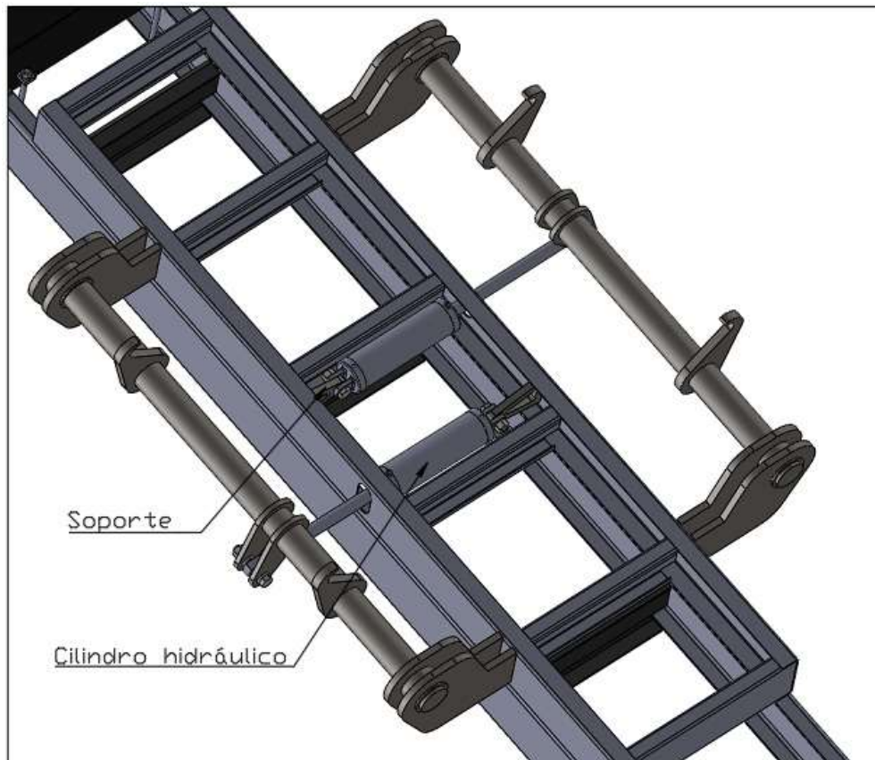
Figura 9.10. Conjunto Plataforma - Sistema de vuelco.
