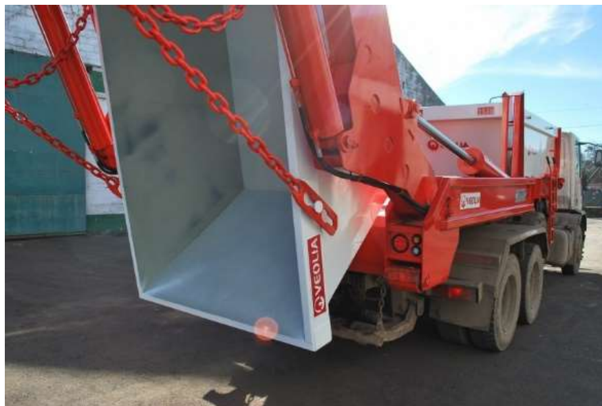
Figura 2.4. Maniobra de Vuelco del Contenedor
