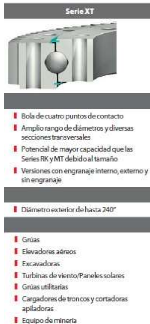
Figura 5.1. Rodamiento corona de giro KAYDON. Serie XT
