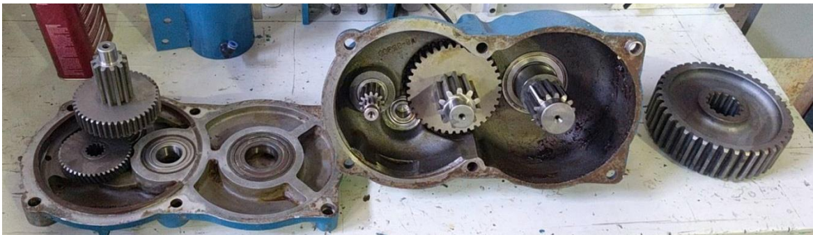
Fig. 3.8. Tapa, cuerpo y engranajes de transmisión de caja de reducción con relación 160:1.
