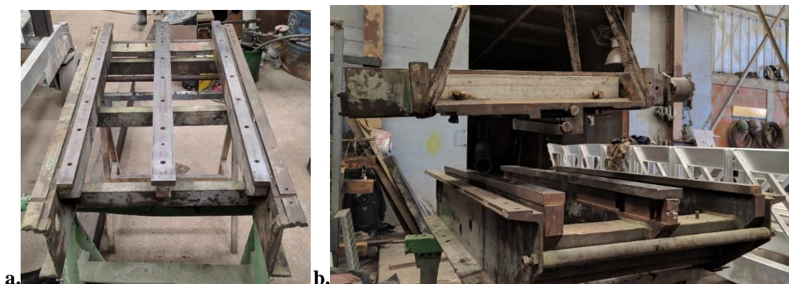
Fig. 3.2. a. Vistas superior de perfiles U y colisas de guía. b. Montaje de carro de avance sobre guías lineales.
