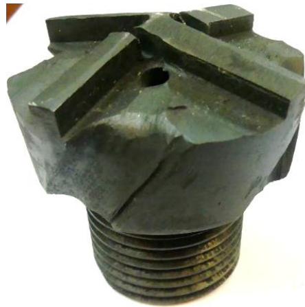
Fig. 3.15. Cortador de 4 filos de acero SAE-AISI O2 templado y revenido. Canales de lubricación y descarga.
