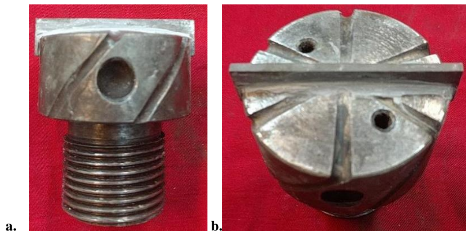
Fig. 3.93. Placa de WC pegada en punta porta filo sin ángulo de punta. a. Vista lateral b. vista superior.
