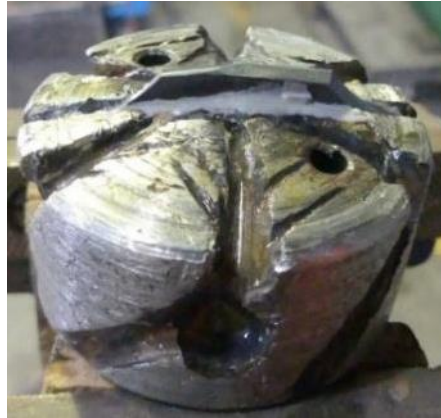
Fig. 4.36. Cortador de 2 filas de WC con FF (Filo Fracturado). Forma típica de fractura.
