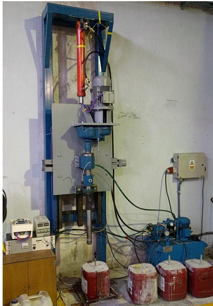
Fig. 3.42. Montaje del equipo de perforación. De izquierda a derecha, variador de velocidad, alimentación de equipos periféricos, equipo de control de avance y fuente de potencia regulable, perforadora, unidad hidráulica.
