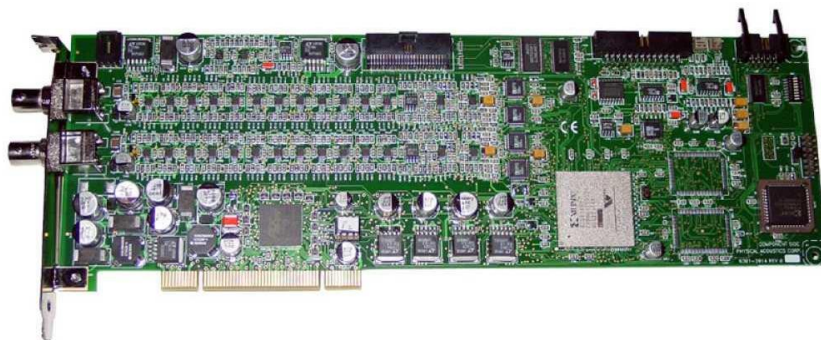
Fig. 1.18 Placa integrada PCI de EA de dos canales para PC.
