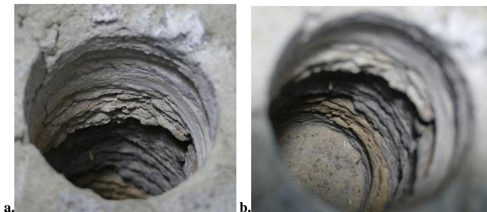
Fig. 3.25. Perforación en condición FF donde se observa una calidad irregular de terminación. a. Cambio de forma de corte en lugar de la fractura del filo. b. Foco en la parte inferior del pozo luego de la fractura.
