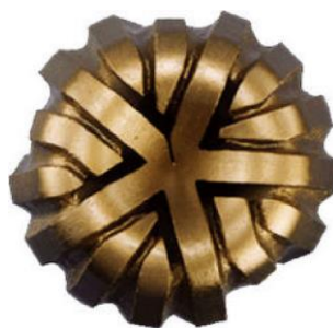
Fig. 2.24. Brocas de diamante impregnado donde se aprecian las cuchillas recubiertas de estos, no pudiéndose distinguir los diamantes. [Schlumberger 2001]
