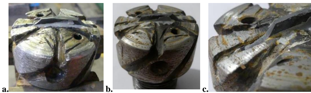
Fig. 3.23. Fotografías de filo fracturado (FF) en diferentes ensayos, donde se observa la fractura del filo en la zona periférica del cortador, quedando solamente la parte central del mismo a. b. Fractura de la broca en probetas de calibración. c. Ampliación de zona de fractura.
