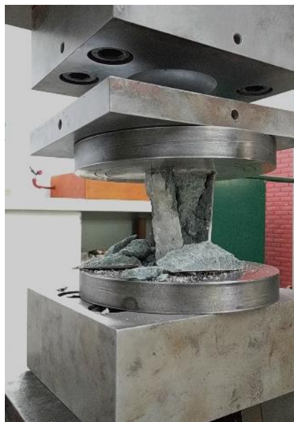
Fig. 3.39. Probeta de elemento cementación composición 0.8:0.2:3, luego del ensayo de compresión uniaxial a rotura.
