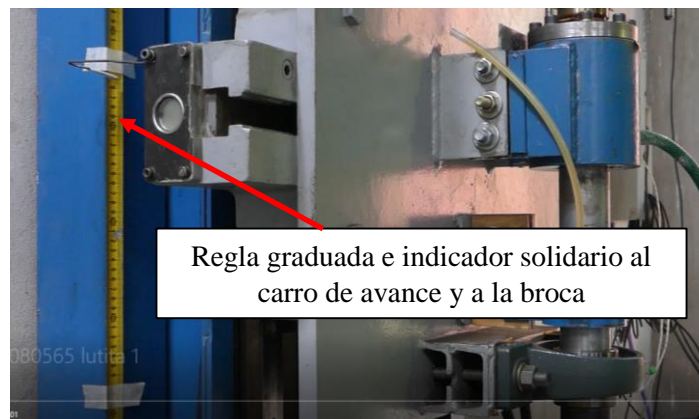
Fig. 3.45. Fotograma de filmación de la taladradora para registro de la posición del cortador.
