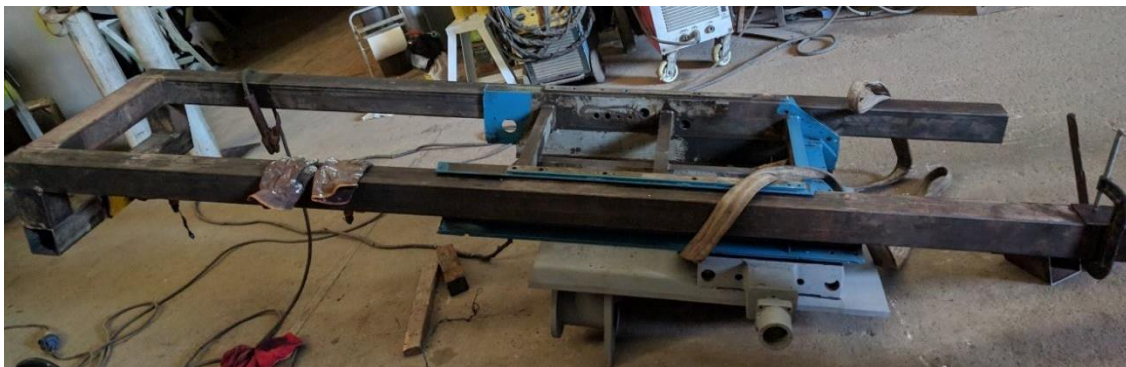
Fig. 3.4. Marco de soporte de la perforadora, unido al sistema de deslizamiento.
