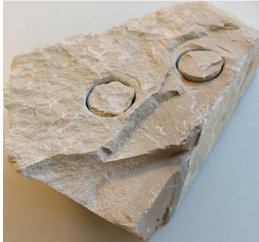
Fig. 3.38. Extracción de “plugs” sobre muestra de roca caliza perpendicular al sentido de estratificación.
