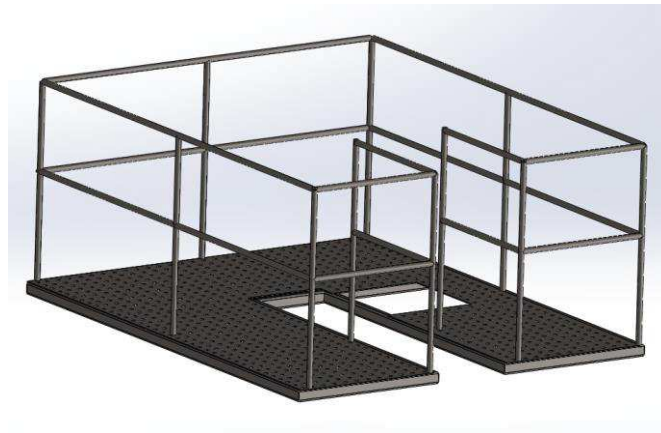
Figura V – 3. Plataforma de servicio.
