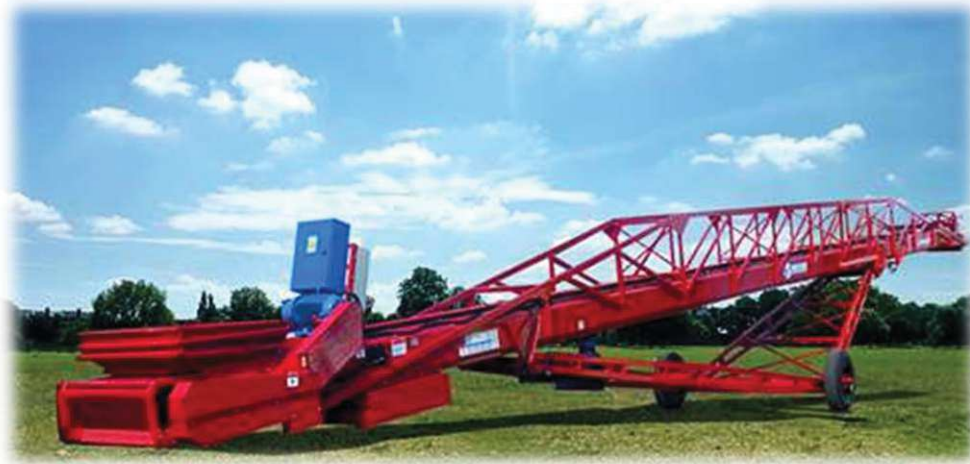
Figura II – 1. Ilustración cinta transportadora.
