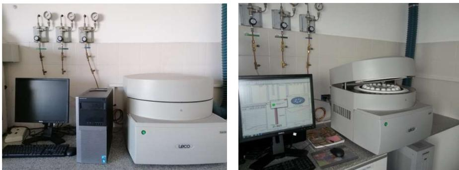
**Figura 18:** Equipo Analizador termogravimétrico, TGA 701
