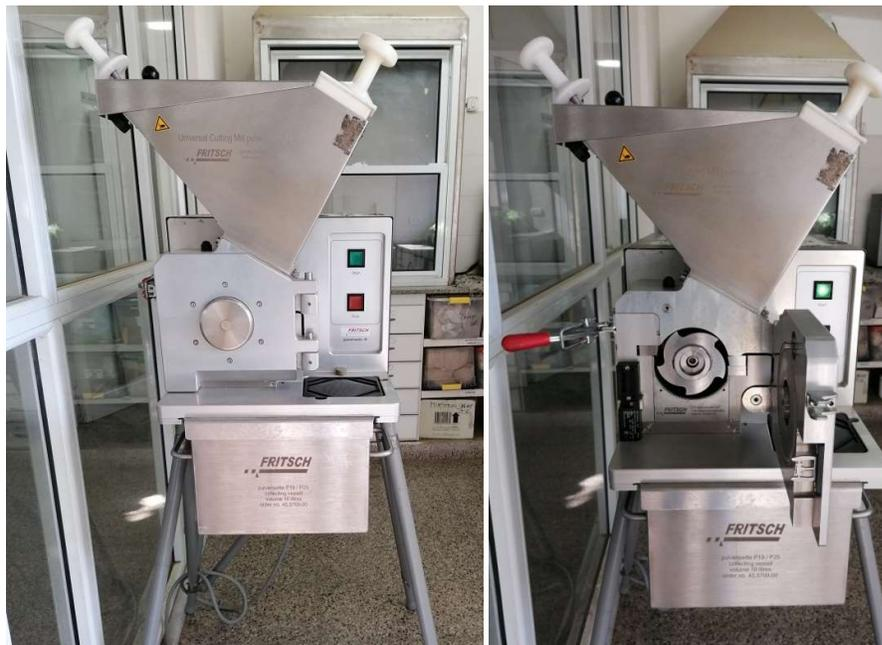
**Figura 17:** Molino de corte para la preparación de muestras, marca Fritsch, modelo Pulverisette 19.
