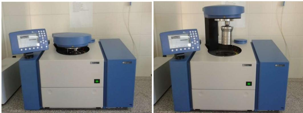
**Figura 19:** Bomba calorimétrica, marca IKA, modelo C5000
