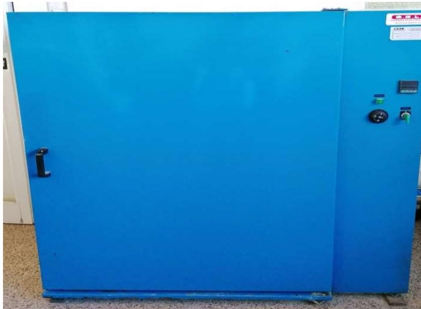
**Figura 16:** Estufa marca ORL, con circulación forzada de aire y con controlador automático de temperatura
