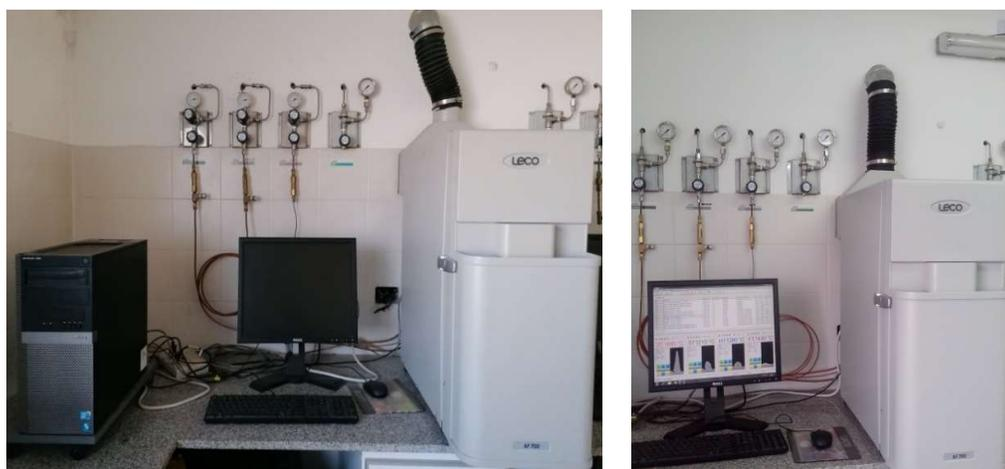
**Figura 20:** Equipo de fusibilidad de cenizas, marca LECO, modelo AF700
