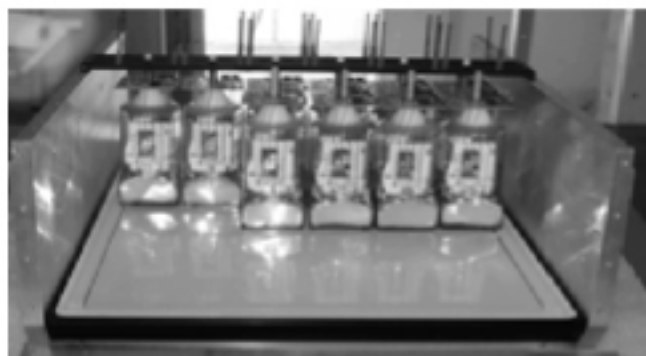
Fig. 14. Configuración del detector, cristal de INa(Tl) de 300x400x25mm 3 con un arreglo de 6x8 fotomultiplicadores cuadrados de 50mm
