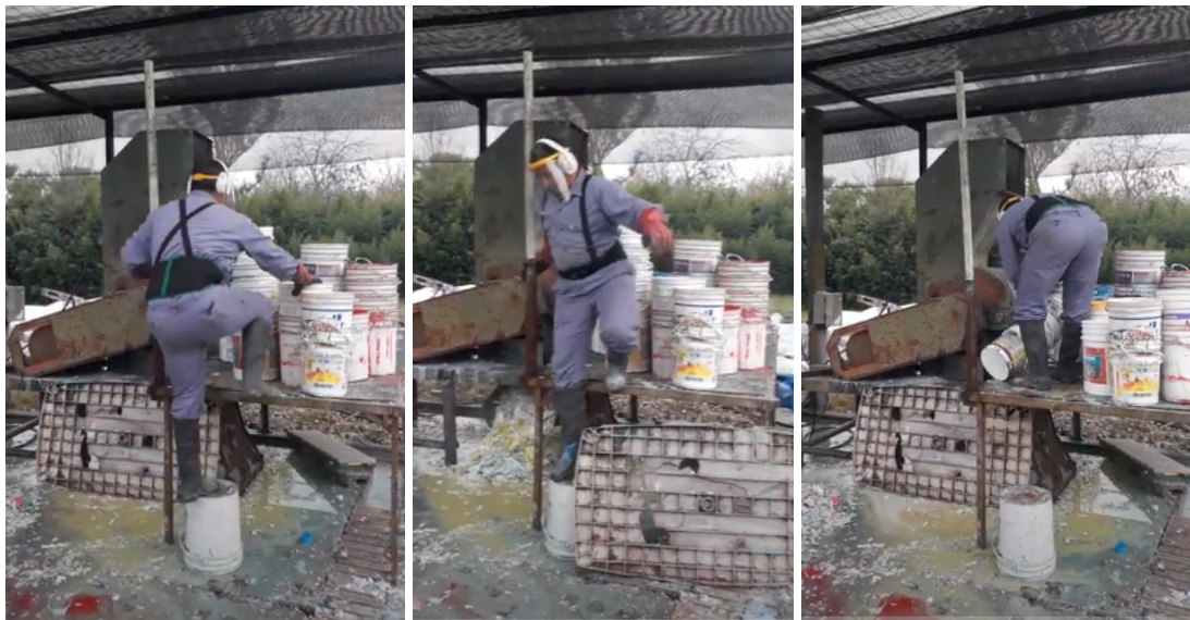
Figura 299. Operaciones inseguras en la alimentación del molino a martillos
