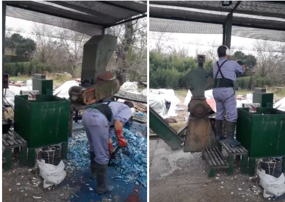
Figura 300. Esfuerzo físico y operaciones inseguras en el molino a cuchillas
