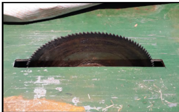
Figura 298. Disco de corte de la sierra circular de banco sin protección
