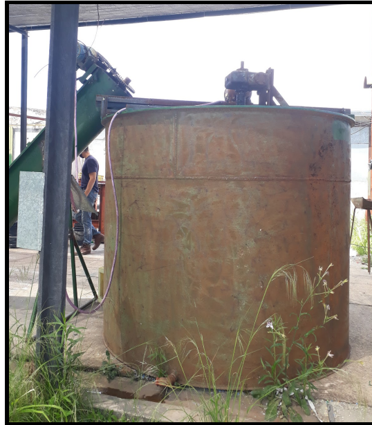
Figura 13. Tanque de lavado
