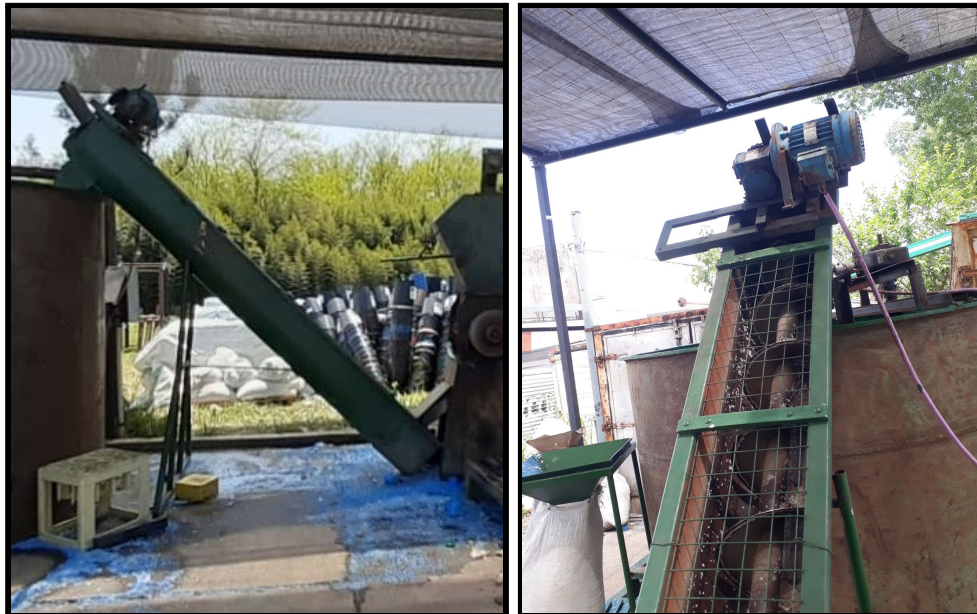
Figura 44. Vista lateral y superior del transportador de tornillo sin fin
