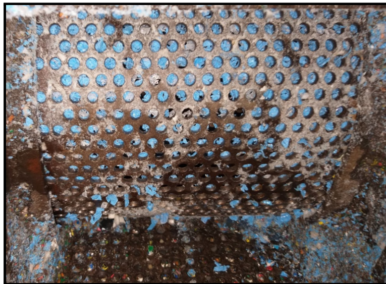
Figura 43. Criba o tamiz del molino a cuchillas
