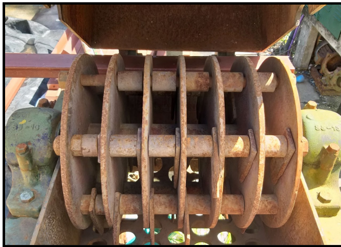
Figura 38. Interior de la cámara de molienda del molino a martillos
