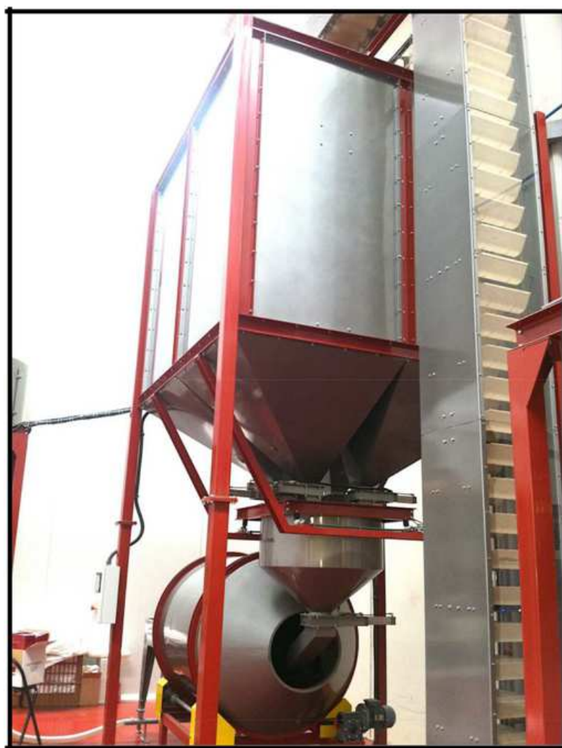
Figure 53: Elevador de Cangilones vista 2 Fuente: INNOenvas
