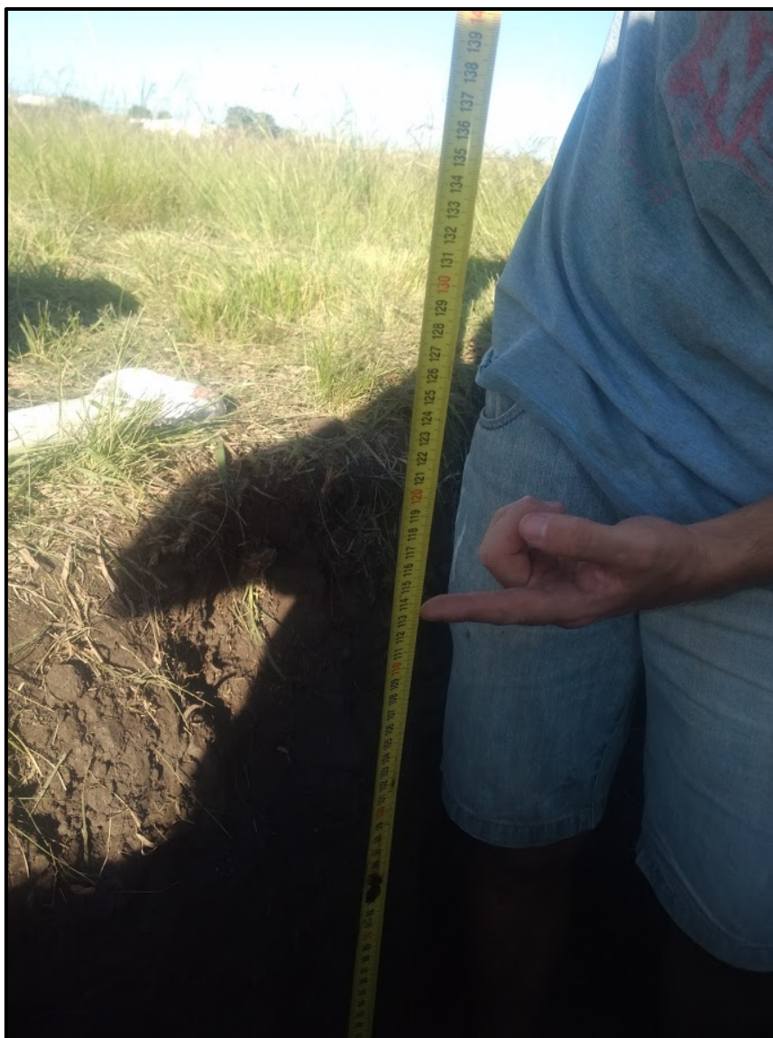
Imagen 7-9 Verificación de profundidad de pozo P2 (114cm)
