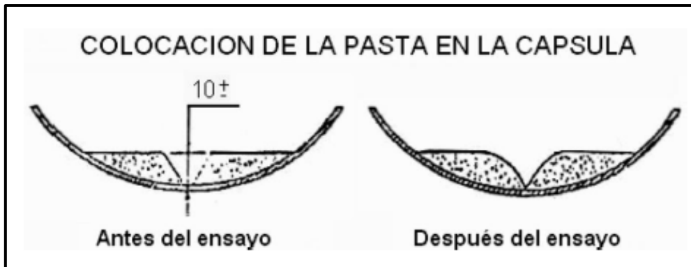
Imagen 7-11 Colocación de la pasta antes y después del ensayo
