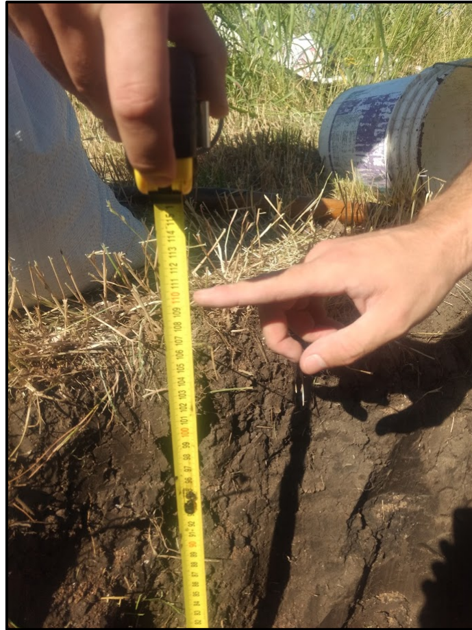
Imagen 7-5 Verificación de profundidad de pozo P1 (110cm)
