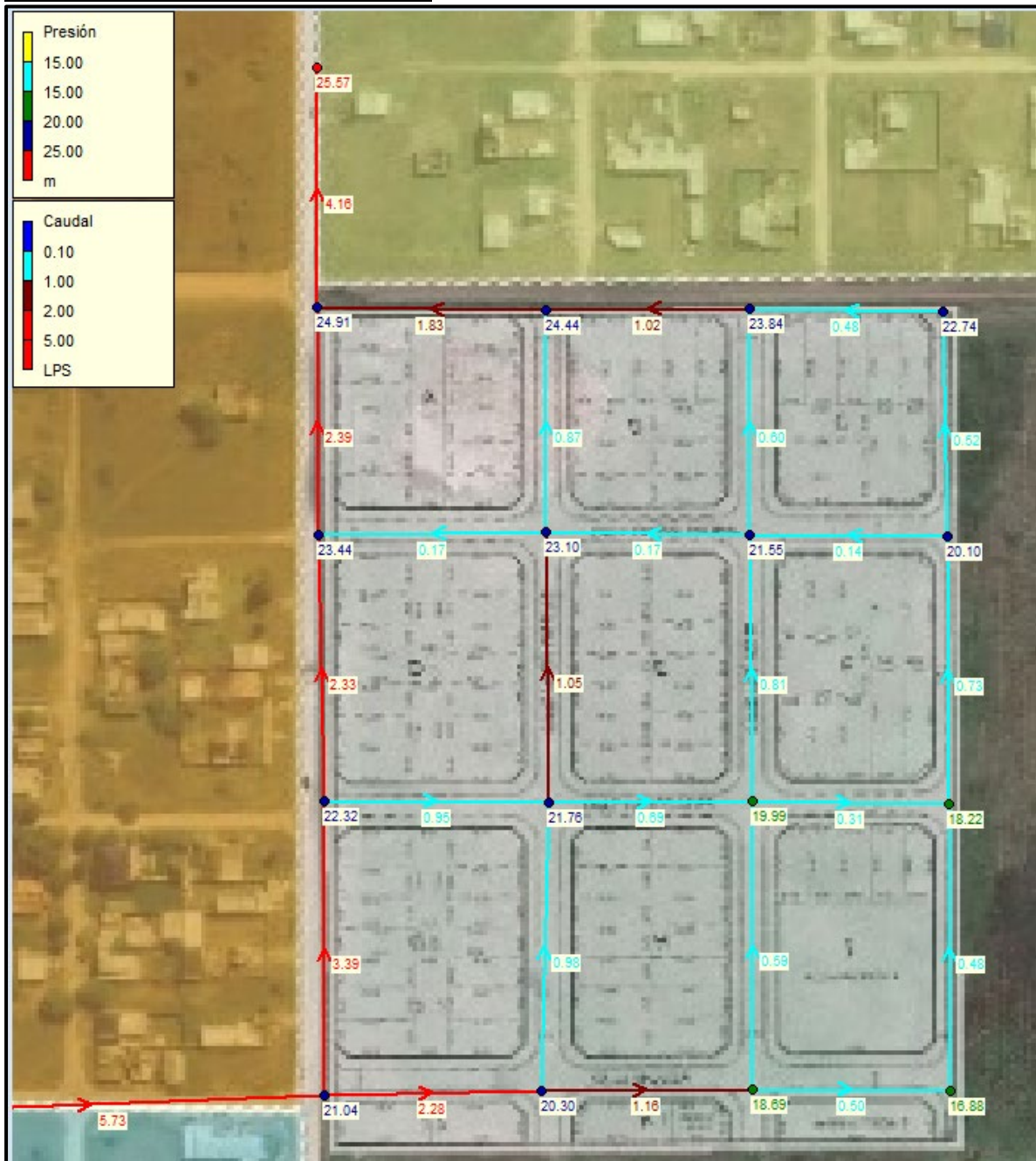
Imagen 9-5 Resultados de presión y caudal en red de agua
