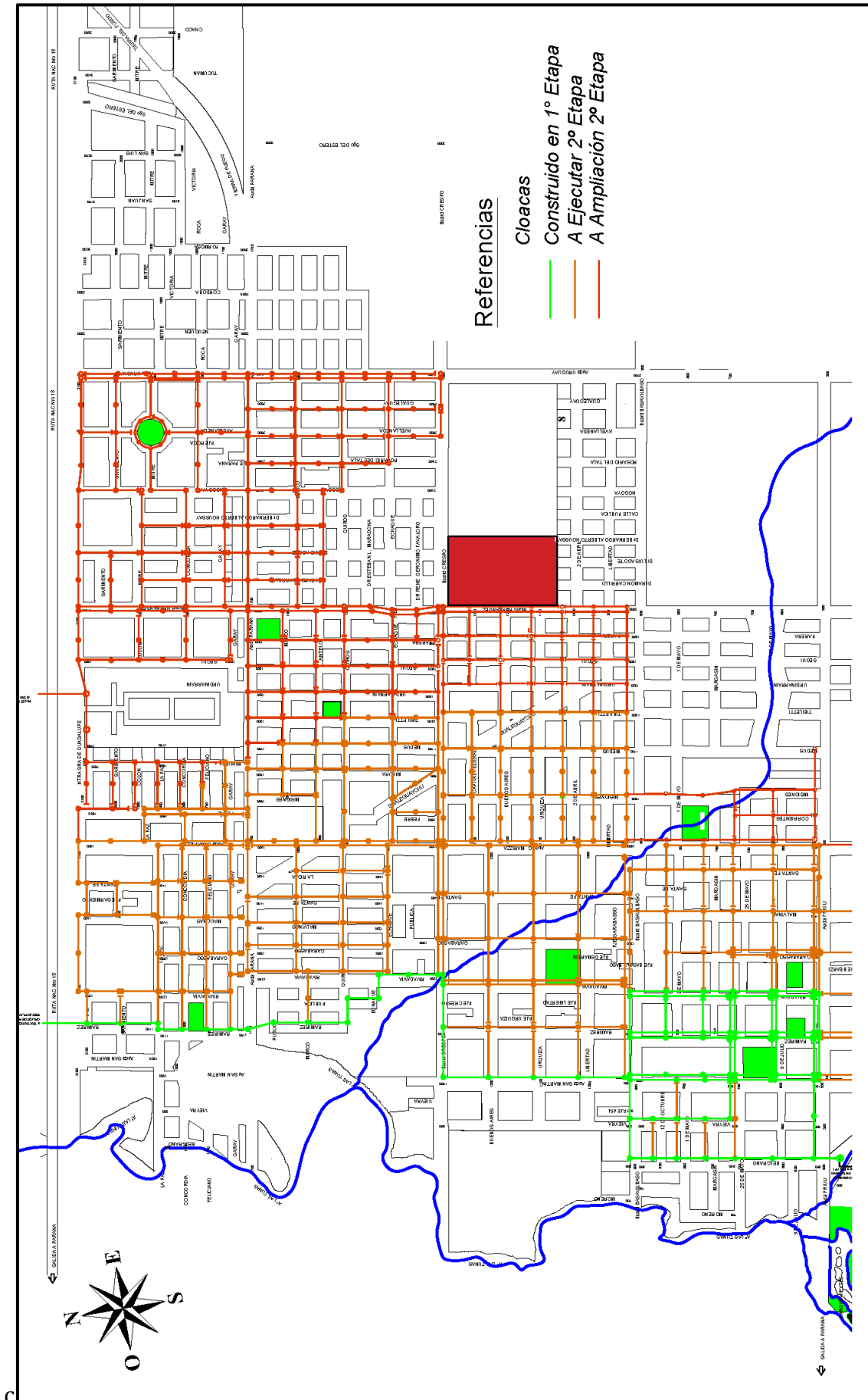
Imagen 3-5 Red de cloaca y ampliaciones
