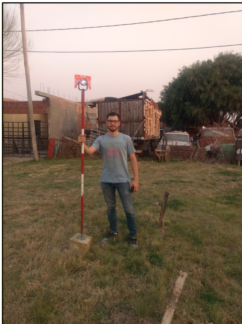
Imagen 4-15 Medición del punto fijo IGN
