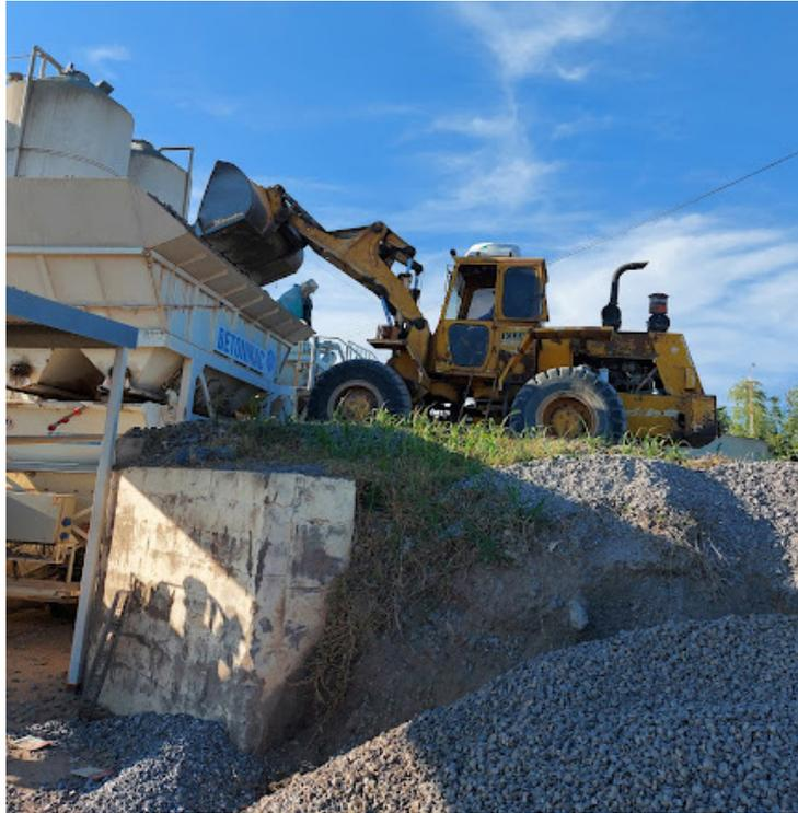
*Imagen: Carga de Tolvas con pala cargadora*
