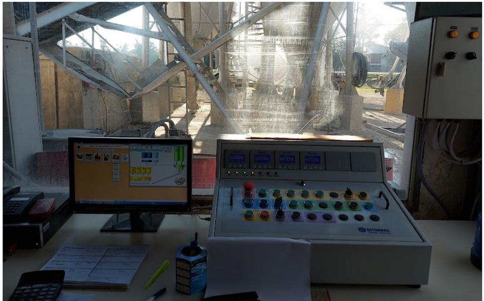
*Imagen: Software de funcionamiento de la planta dosificadora y consola manejo.*
