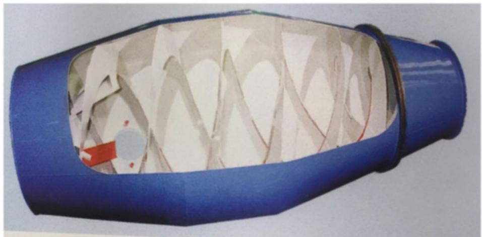
La velocidad de rotación no es constante en todo el viaje a obra. Se utilizan velocidades entre 14 y 19 revoluciones por minuto para la etapa de amasado. La duración de esta etapa depende de la cantidad de hormigón presente en el trompo, donde se amasa 1 minuto por metro cúbico de hormigón. Finalizado este tiempo, se reduce la velocidad
