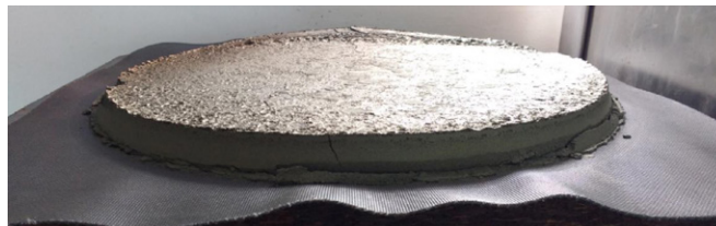
Figura 5. Torta formada sobre la tela filtrante, en el filtro Larox PF 0,1.
