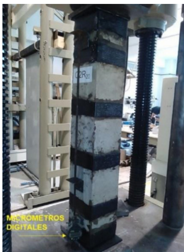
Figura 5. Ensayo de compresión uniaxial.
