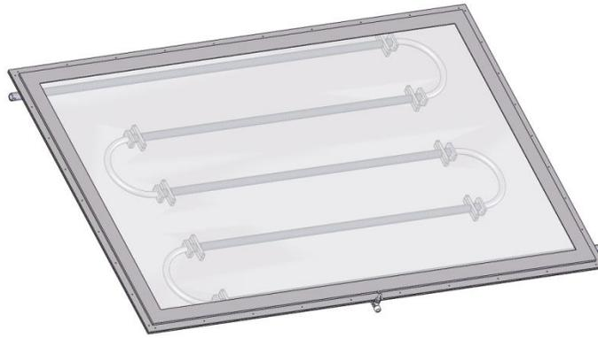
Fig. 25 Colector con serpentín
