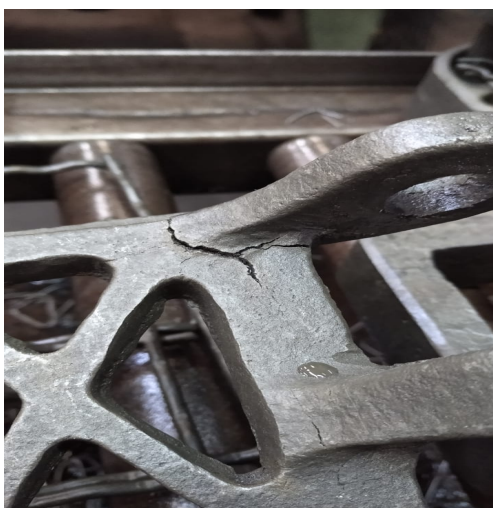
Figura N°51 y N°52. Imágenes de fisura y posterior soldadura de grilla respectivamente.
