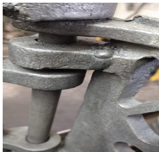
Figura N°51 y N°52. Imágenes de fisura y posterior soldadura de grilla respectivamente.
