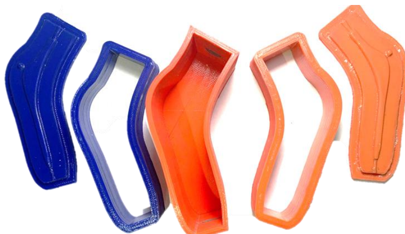
Ilustración 34. Negativos de moldes obtenidos por impresión 3D.
