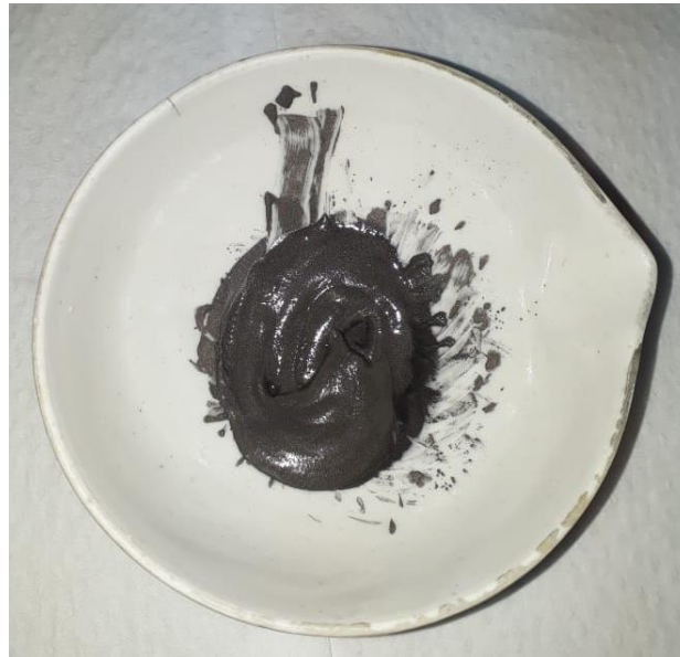
Ilustración 29. Barro producido luego de mezclar los polvos con el monómero.
