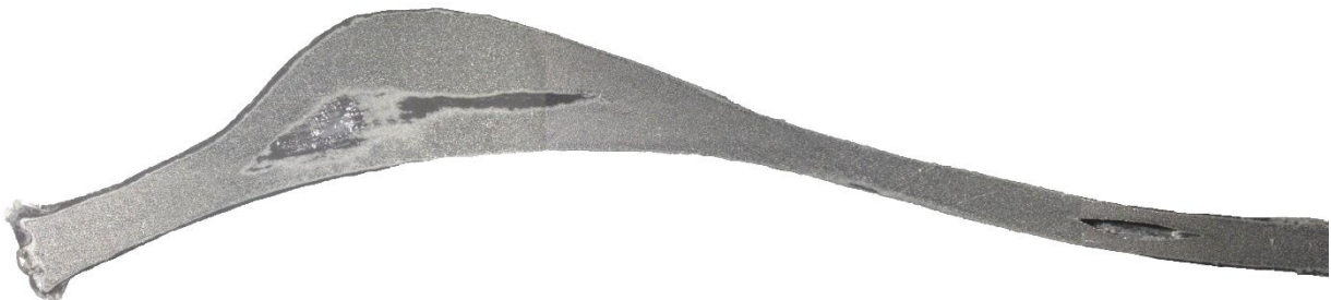
Ilustración 39. Prototipo de tallo femoral a escala sinterizado.
