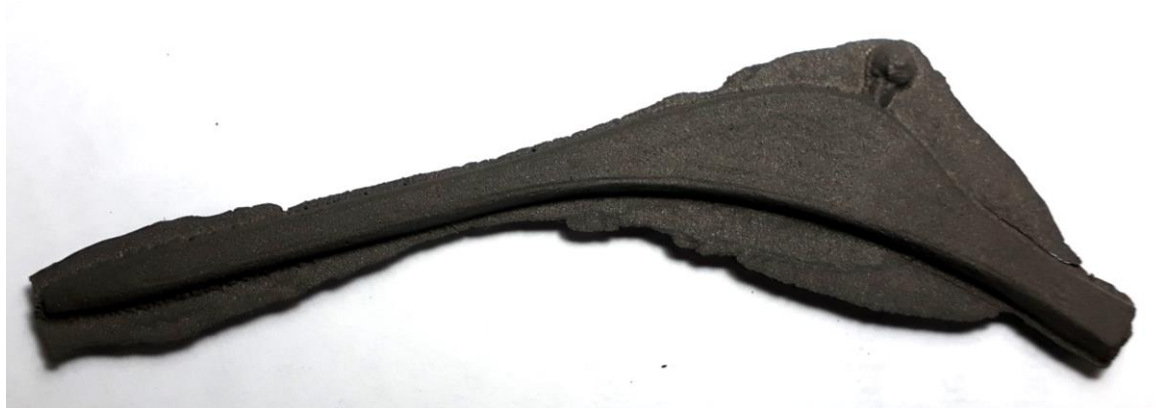
Ilustración 38. Tallo femoral a escala antes de la sinterización.
