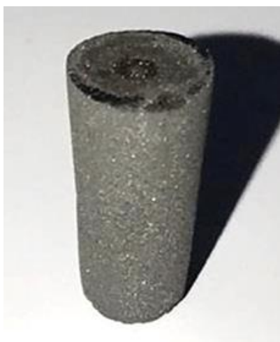
Ilustración 37. Probeta cilíndrica en verde.
