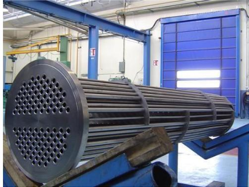
Fig. 3-26 - Interior Casco y Tubo.
