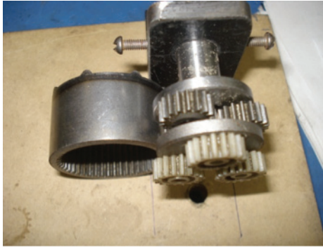
Sistema multiplicador, planetario (Imagen 6)
