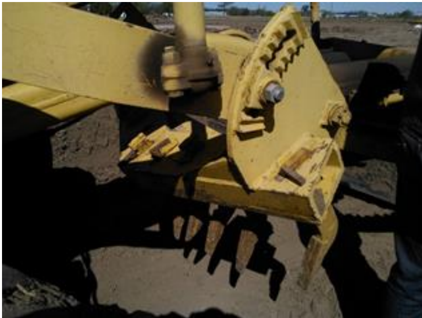
Figura 13: Escarificador anexo a la motoniveladora
