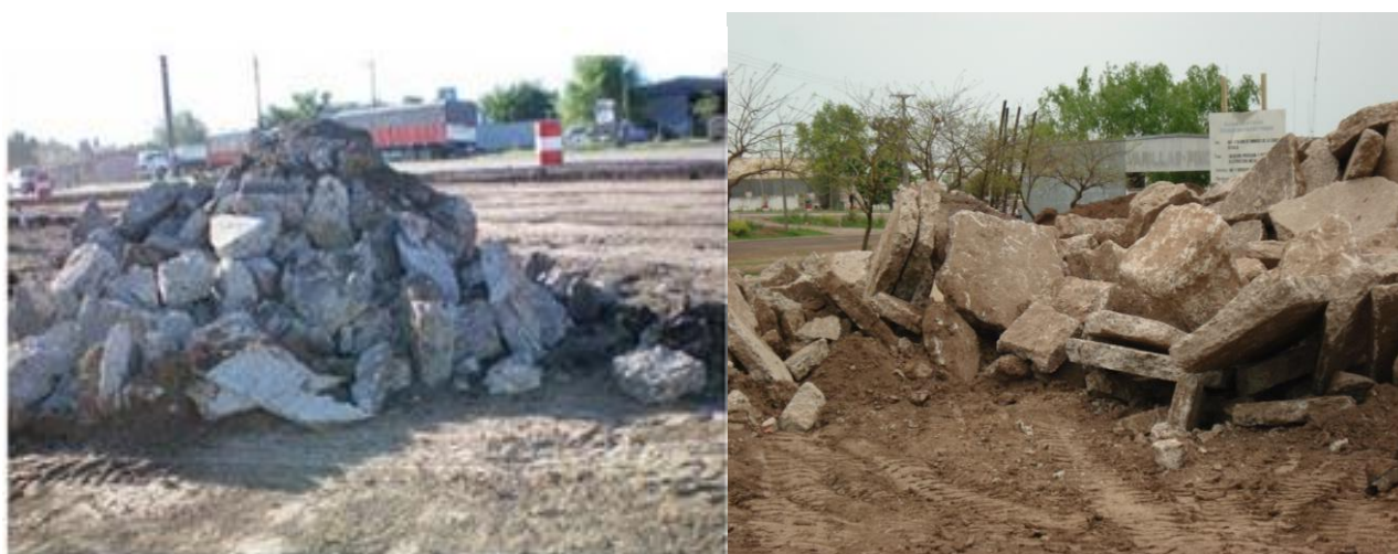
Figuras 12 y 13. Escombros de hormigón (Tonda et al. , 2008)
