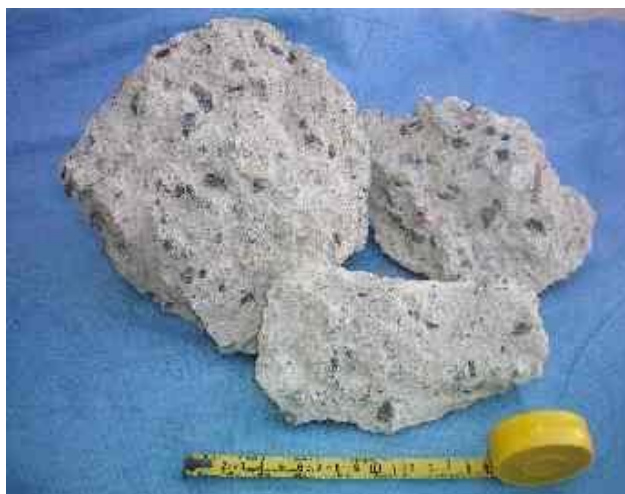
Figura 14. Rotura de hormigón de demolición (Tonda et al. , 2008)
