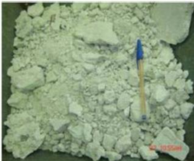
Figura 31. Yeso de aplicaciones húmedas (YH), (Begliardo et al. , 2013)
