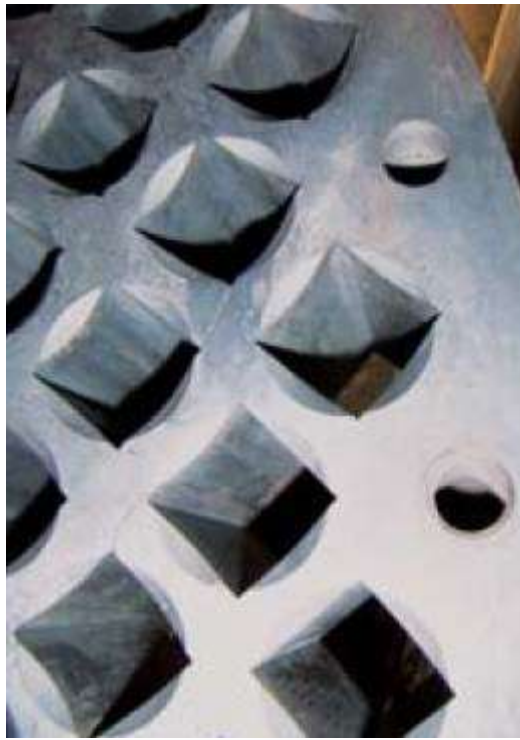
Figura 8: Matriz plana para cubeteadoras de eje vertical
