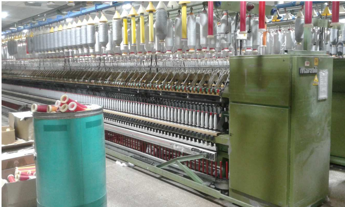
Fotografía 6.2 – Continua de hilar marca MARZOLI en la planta.
