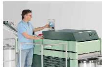
Ajuste automático del punto de acción de la regulación mediante AUTOset en aprox. 1 minuto.
