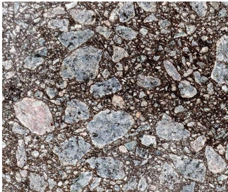
Figura 13. Escaneo en alta resolución de un corte en sentido transversal al fresado
