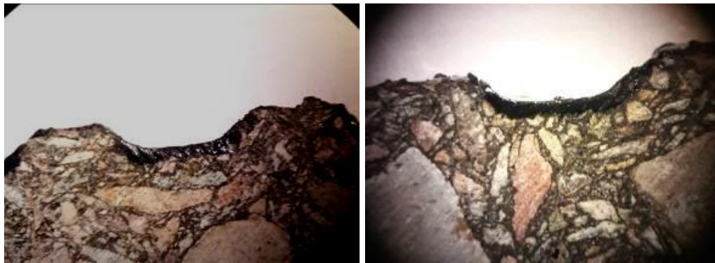
Figura 2. Deposición excesiva de un riego en los valles del fresado
