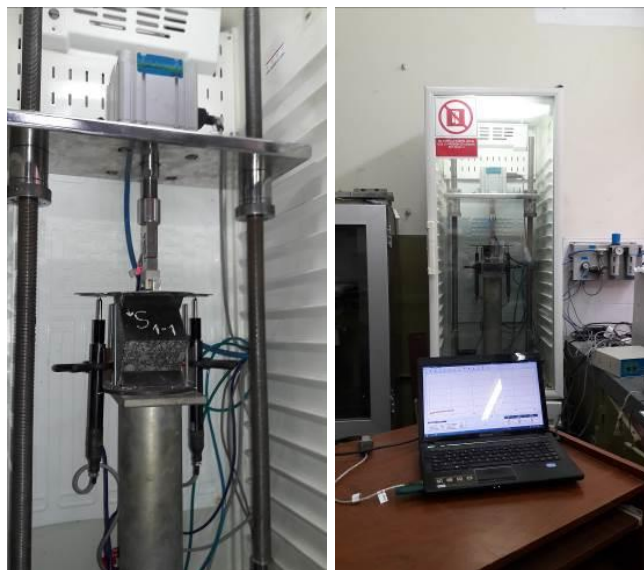
Figura 15. Imágenes durante el ensayo a fatiga de una de las probetas cúbicas
