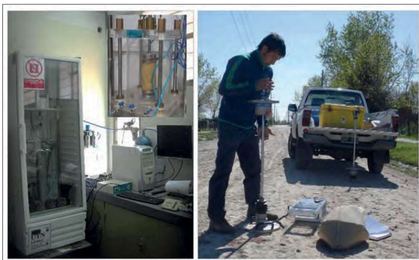
Figura 4: Equipo de módulo resiliente (izq.) y light weight deflectometer (der.)
