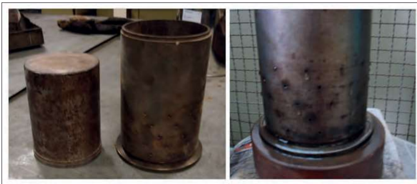
Figura 12: Molde y pistón (izq.) y salida de agua por rotura de emulsión durante el molde de probetas (der.) en método Marshall modificado
