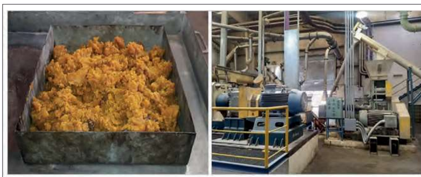
Figura 8: Desgomado de soja (izq.), proveniente de extracción de aceite y otros compuestos (der.)
