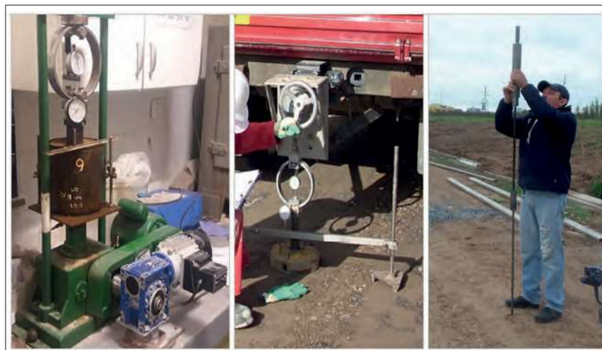
Figura 5: VSR en laboratorio (izq.). VSR in situ (centro) t DCP (der.)
