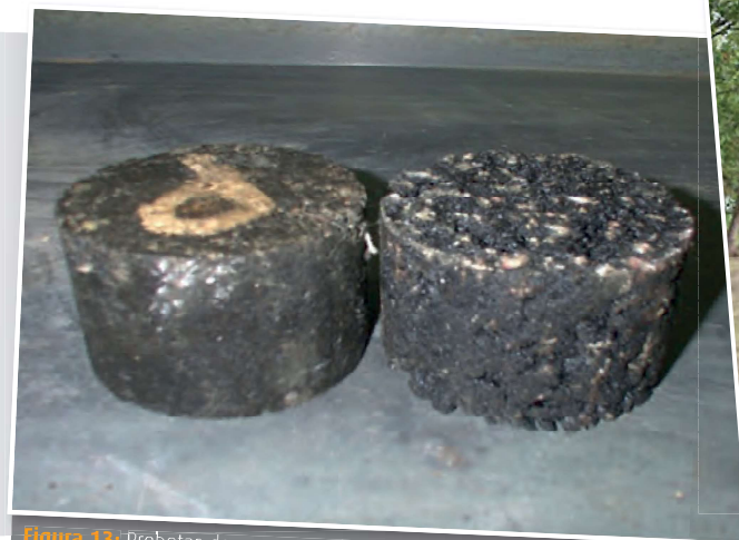
Figura 13: Probetas de concreto asfáltico en frío generadas
