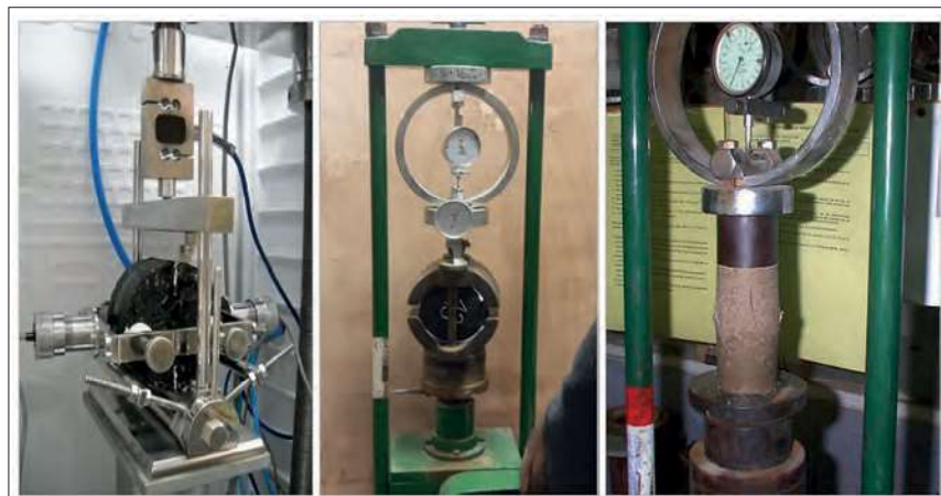
Figura 6: Módulo dinámico (izq.), Marshall (centro) y RCI (der.)
