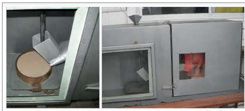
Figura 10: Equipo adaptado por el LEMaC para el control de paliativos de polvo
