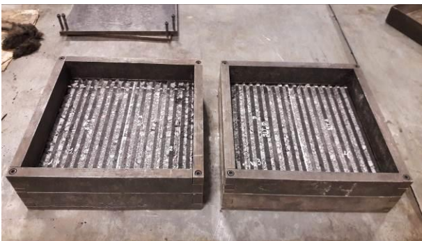
Figura 9. Bases para las probetas con fresado simulado para Caso 4
