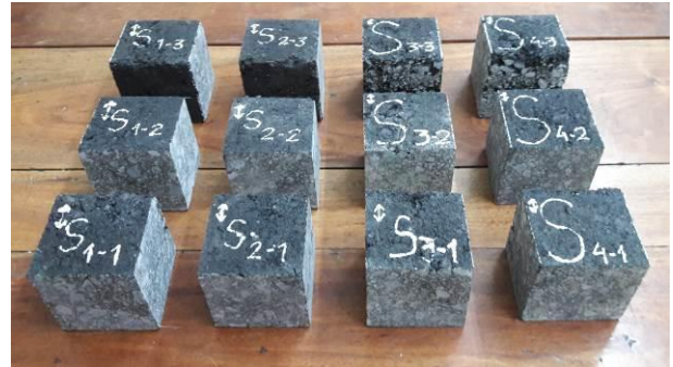
Figura 11. Probetas cúbicas generadas por aserrado para análisis a fatiga, Caso 4
