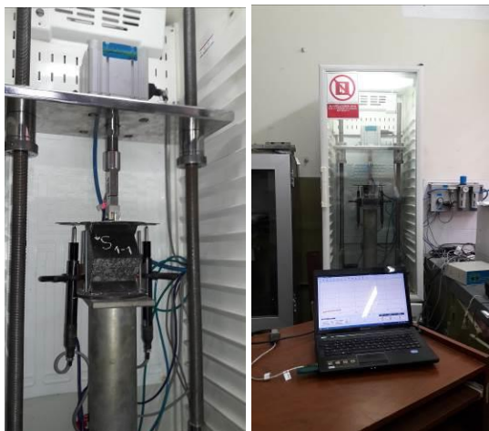
Figura 14. Imágenes durante el ensayo a fatiga de una de las probetas cúbicas Fuente: elaboración propia
