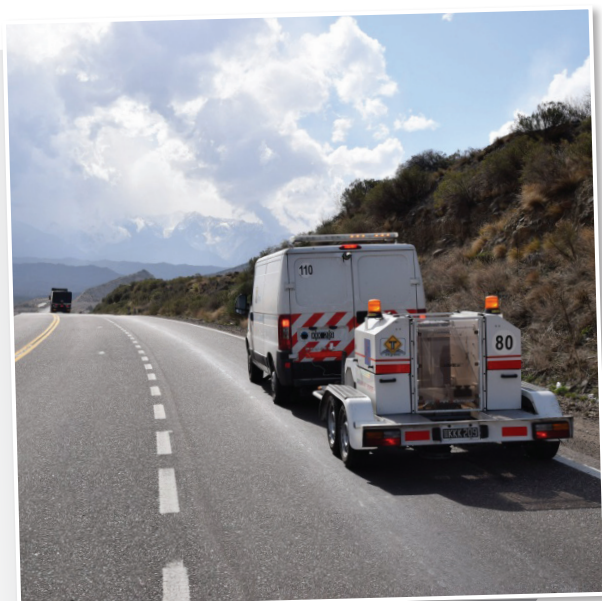
Figura 4B Equipos de alto rendimiento. Medición de deflexiones con FWD.
