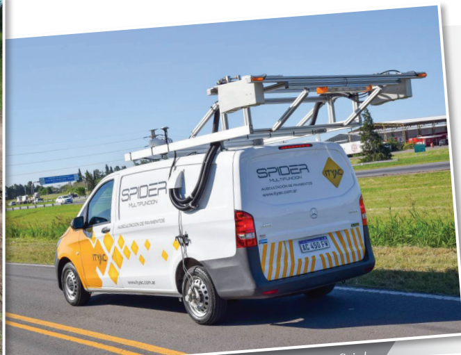
Figura 4A Equipos de alto rendimiento. Relevamiento superficial con equipo láser.
