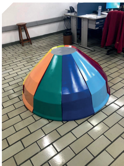
Alternativas de revestimientos anti-desgaste. Cada color representa una opción de manto diferente.
