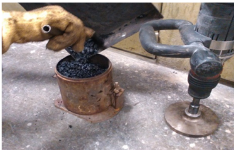
FIGURA 3 Colocación de la mezcla en el molde.
