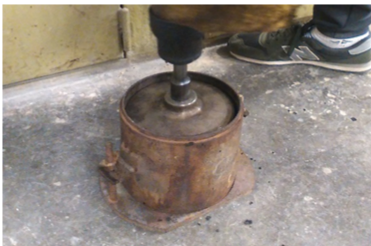
FIGURA 4 Moldeo manual de las mezclas asfálticas mediante martillo percutor.
