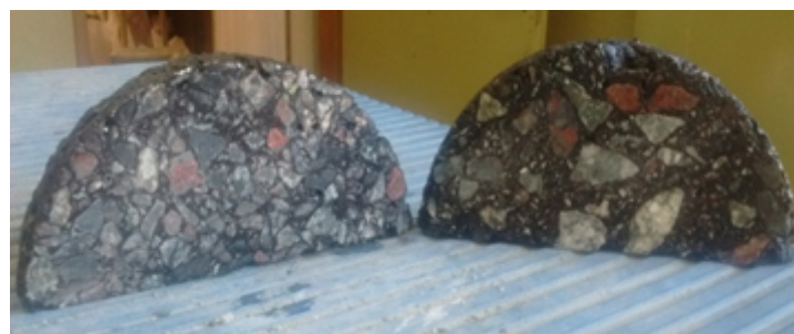
FIGURA 20 Diferencia granulométrica evidenciada en probetas exteriores.
