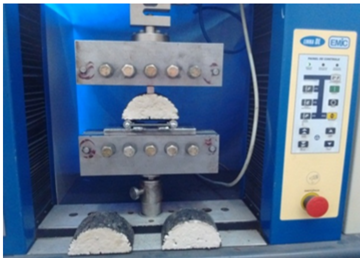
FIGURA 6 Equipo EMIC para ejecución de ensayo.
