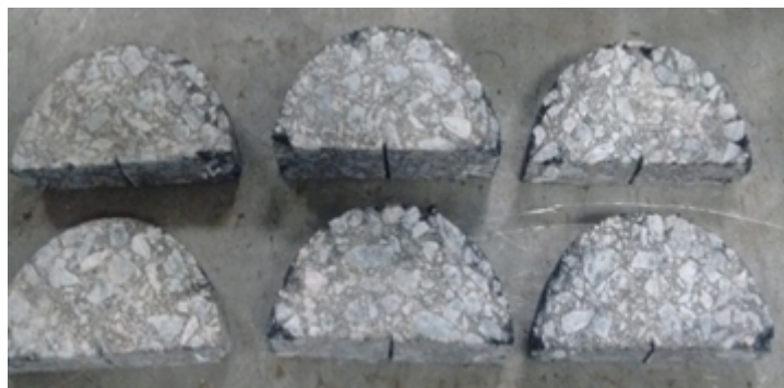
FIGURA 19 Distribución de áridos probetas centrales.
