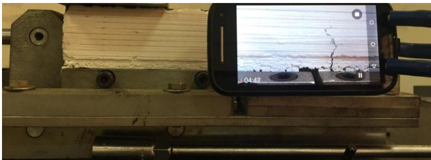
Figura 20. Seguimiento de la propagación de fisura.
