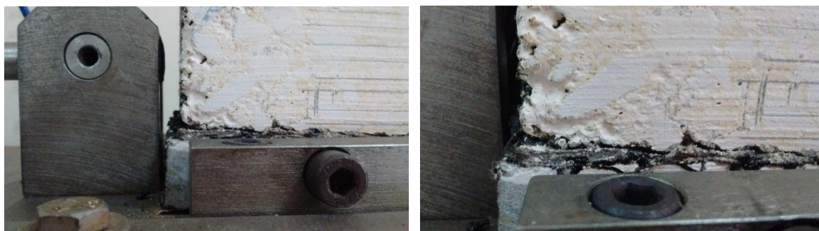
Figura 16. Desplazamiento en la interfase con la placa de hormigón
