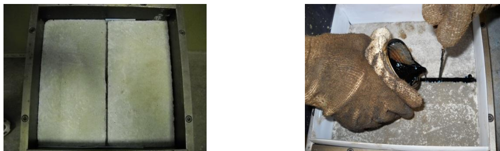
Figura 7. Placas de hormigón, sellado de junta
