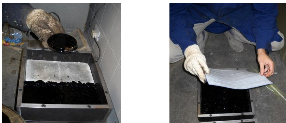
Figura 8 Ejecución del riego y colocación del material geosintético
