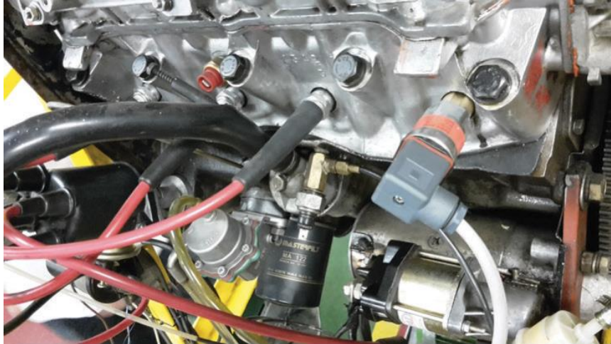
Fig. 3. Montaje en el cilindro n°4 del sensor marca Danfoss MBS 3000 para medición de la presión en tiempo real sin combustión
