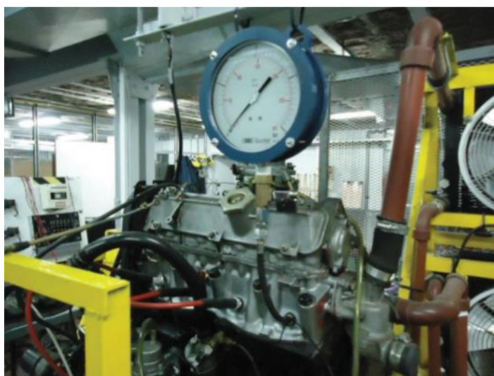
Fig. 1. Compresímetro analógico modificado con válvula de venteo montado en el cilindro n°4 del motor
