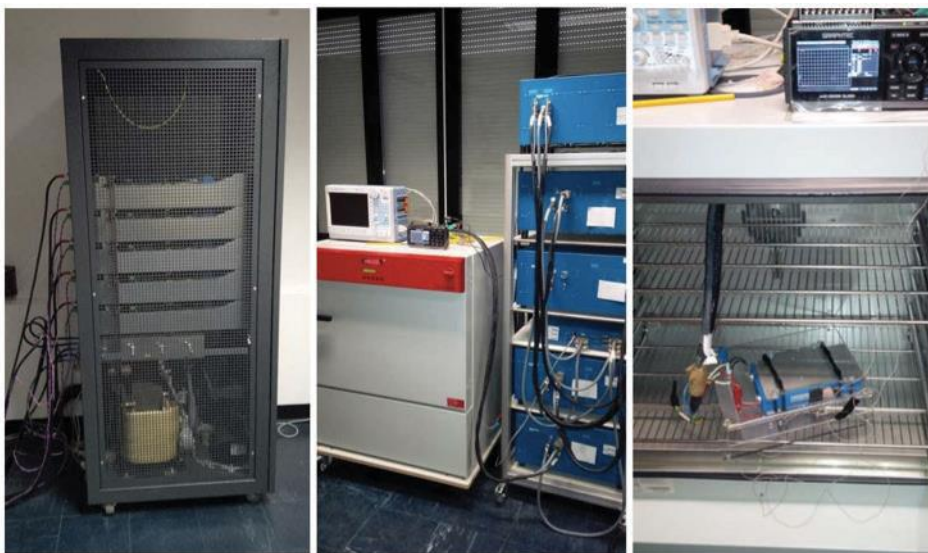
Fig. 10. Equipamiento utilizado para el análisis sobre celdas industriales - (1) BTS-600 - (2) Cámara de temperatura - (3) Celda utilizada de 40Ah
