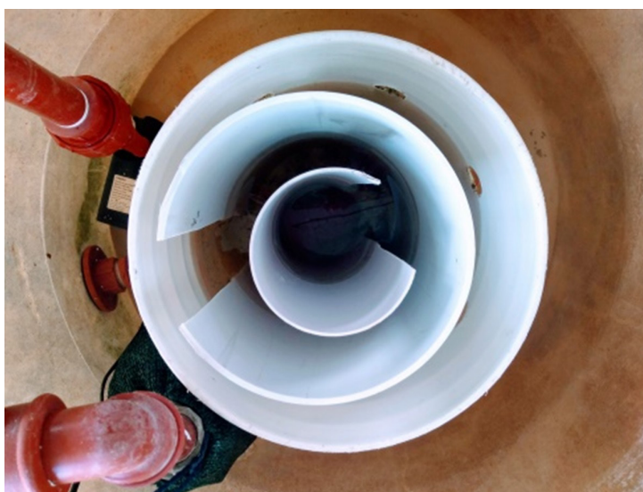
Figura 3. Vista superior del filtro sedimentador del sistema de cultivo
