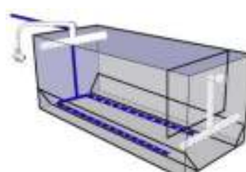
Fig. 2: Esquema del reactor con aireación en (a) Configuración A1 (b) Configuración A2.
