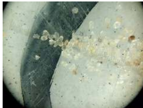
Figura 2. Muestra de arena del Paraná (10x aumentos) con mezcla de tamices 50/70). -
