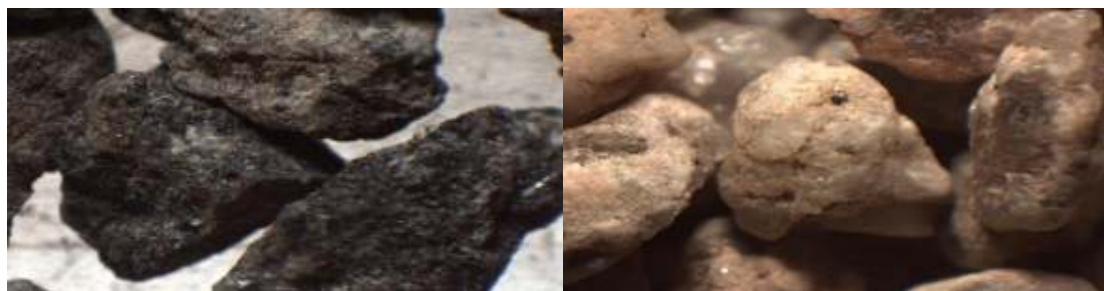
Figura 1: Izq. detalle AT retenido Tamiz N° 8. Der. detalle AN retenido Tamiz N° 8.
