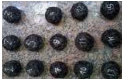
Figura 7: Probetas después de ensayadas (-10 °C) para susceptibilidad térmica.
