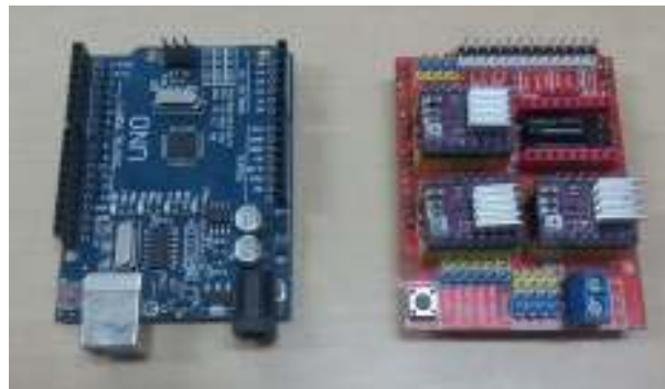
Figura 4. Izquierda placa ARDUINO UNO; Derecha CNC Shield y controladores DRV8825 montados (uno para cada eje).
