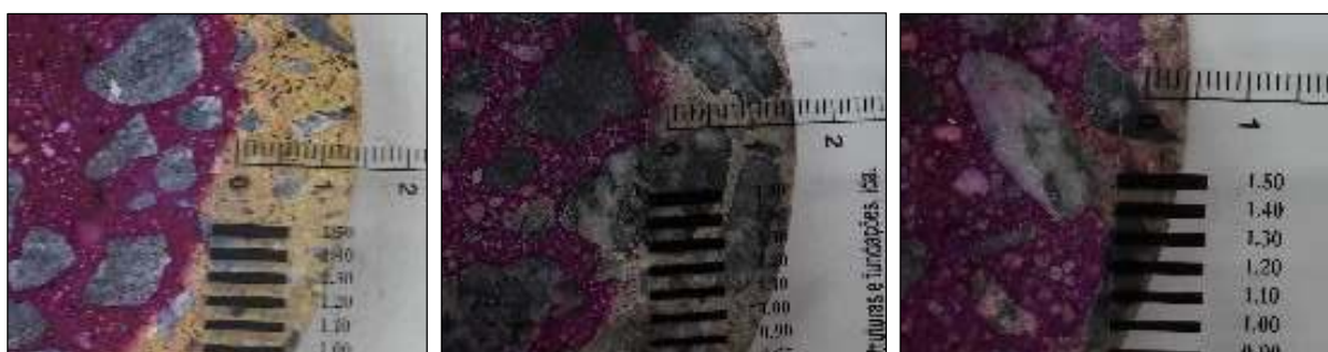
Figura 4 – Medida de la profundidad de carbonatación de algunos hormigones a los 17 días.
