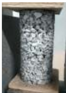
Figura 3 - Ensayo a compresión.
