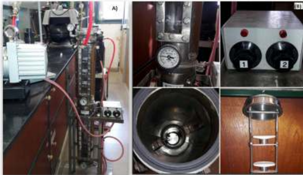
Figura N° 2: Equipo de secado bajo vacío/lioofilizador (A). partes constitutivas (B)
