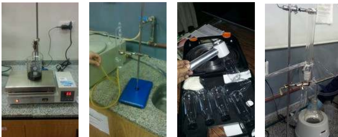
Figuras: 1 Equipo para análisis de viscosidad, 2 viscosímetro, 3 extractor de muestras y 4 equipo de contenido Humedad.
