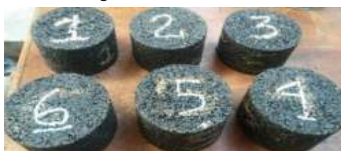
Figura 3: Probetas antes de ensayar a 25 °C a cohesión.
