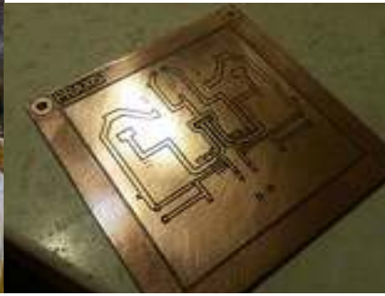
Fig. 7 - PCB recién revelado del módulo de alimentación
