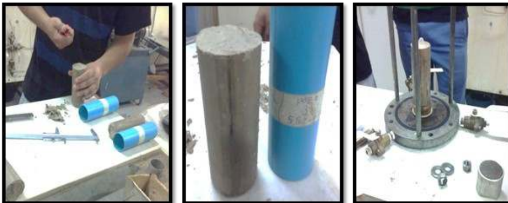
Figuras N° 2, 3 y 4: preparación de la probeta, verificación de paralelismo entre sus caras y posterior armado sobre el cabezal de la cámara.
