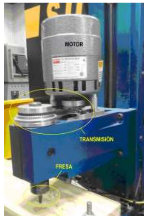
Figura 2. Motor, transmisión y fresa
