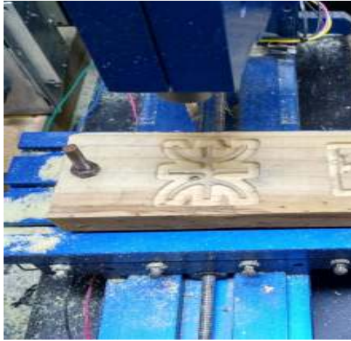
Figura 5. Logo de la UTN realizado sobre un bloque de madera por la fresadora actualizada .
