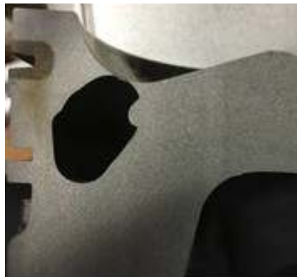
Fig. 3. Defecto por burbuja.
