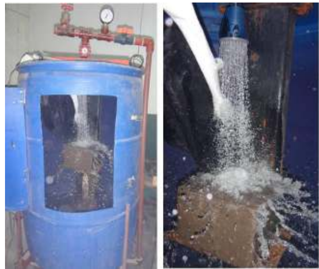
Fig. 4: Ensayo de erosión por caída de agua SEAT en progreso
