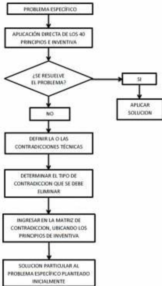
Fig. 7. Esquema Resolución de Problemas, según TRIZ [4].
