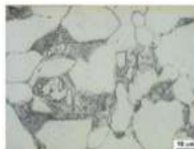
Fig.4 Estructura acero SAE 4140 recocido.
