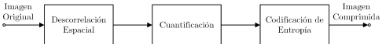
Fig. 1. Arquitectura típica de un sistema de compresión.
