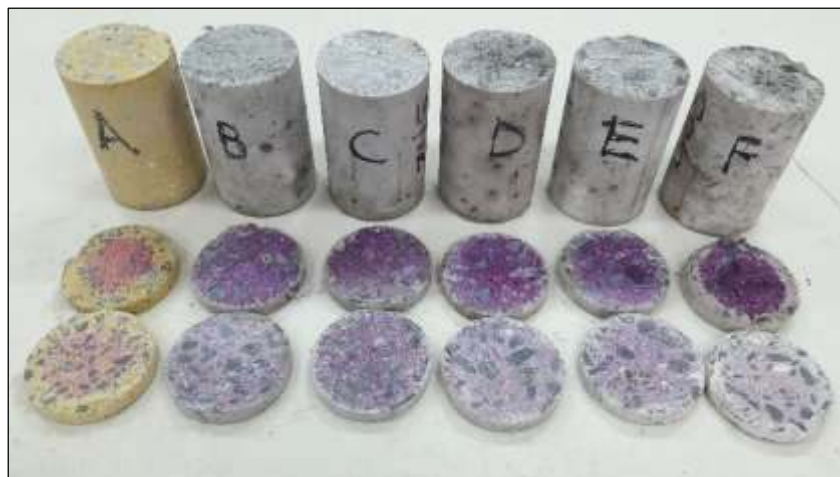
Figura 3 – Profundidad de carbonatación de las muestras ensayadas a 3 y 10 días.
