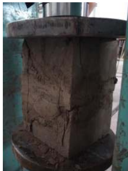
Fig. 2. Rotura de una probeta tras ser ensayada a compresión
