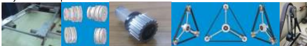
Figura 7: Chasis realizado completamente de aluminio+ruedas triangulares+Solid Edge
