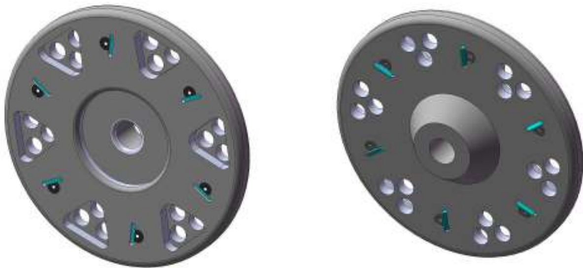
Figura N° 2 Vista anterior y posterior del disco de desbaste
