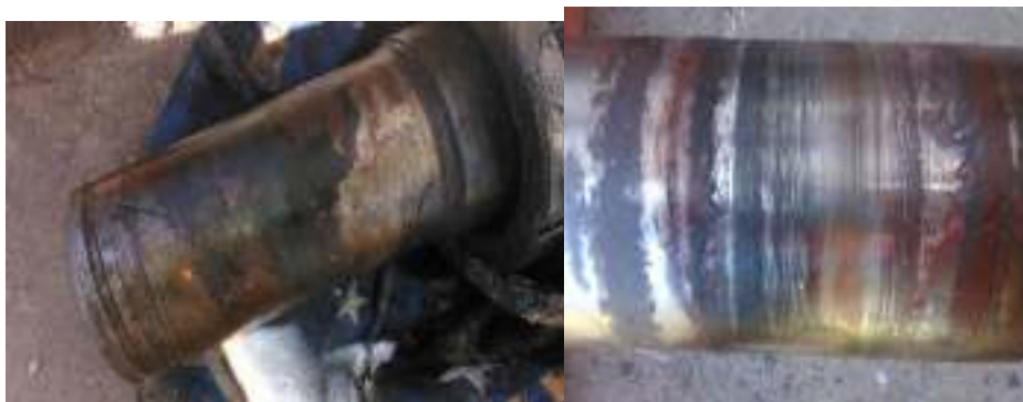
Figura 9. Fotos de los asientos de los manguitos desgastados
