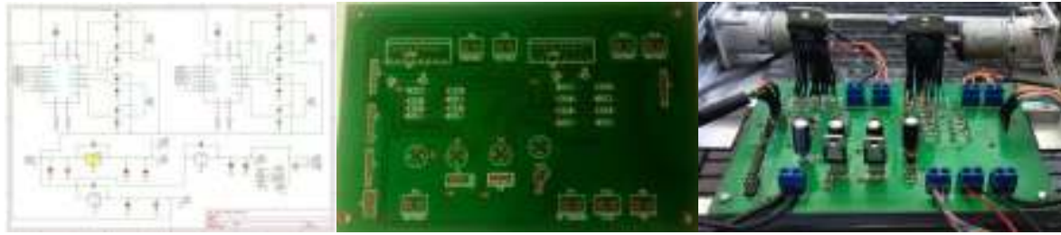
Figura.5 Esquemático del circuito de electrónica de potencia+placa base de control de motores
