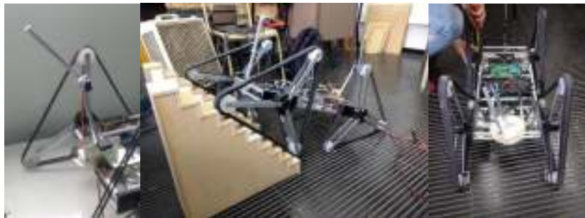
Figura.8: Detalle del manipulador incorporado + robot completo con cámara de transmisión
