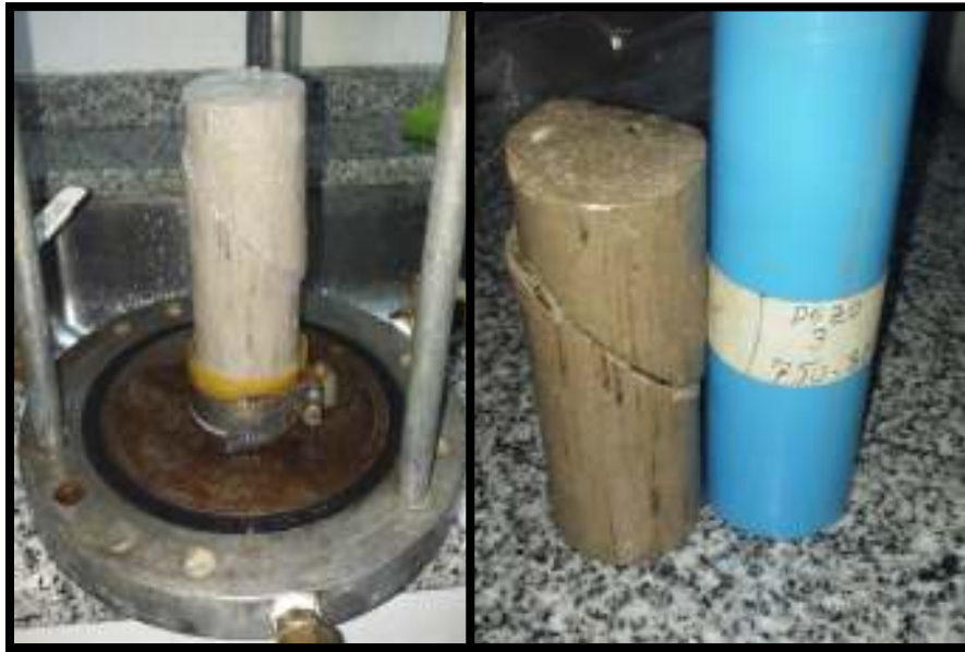
Figuras N° 9 y 10: probeta luego de ensayada recubierta en látex y presentando la rotura a 45° por esfuerzos de corte.
