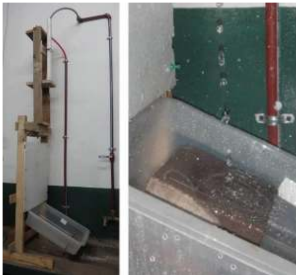
Fig. 3: Realización del ensayo erosión por caída de agua SEAT
