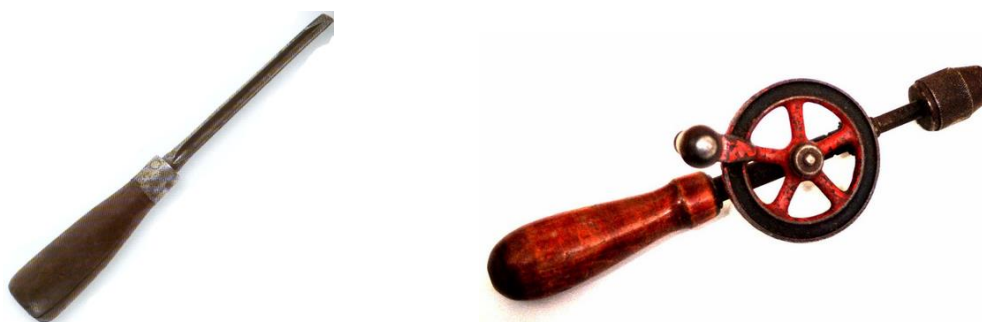
Figura 3- 4 Aquí se puede apreciar uno de los primeros destornilladores de cabeza plana y un tornillo de avance, con punta fileteada que permitía a la broca ingresar con facilidad en la madera
