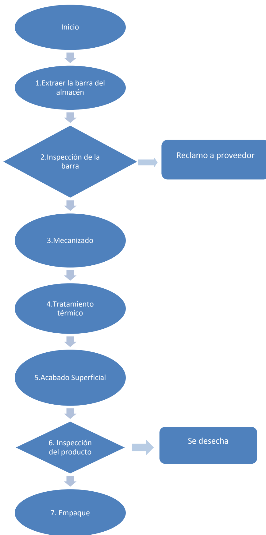
Figura 35 – Se observa el FlowSheet correspondiente al proceso de fabricación
