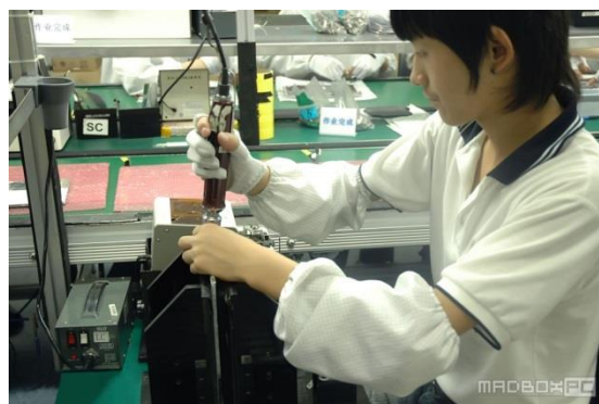
Figura 9 – En la imagen se puede observar parte del proceso de fabricación, puestos de atornillado
