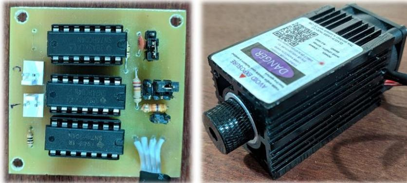
Figura N° 38: Foto de placa transmisora y modulo láser.
