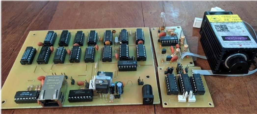
*Figura N° 53: PCB Main (izq.), PCB de Transmisión (esq. inferior) y PCB de Recepción (esq. superior) y laser de transmisión.*
