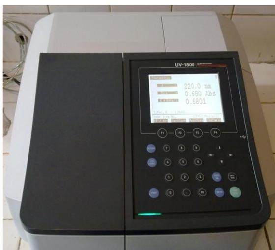
Figura 4: Espectrofotómetro UV- visible
