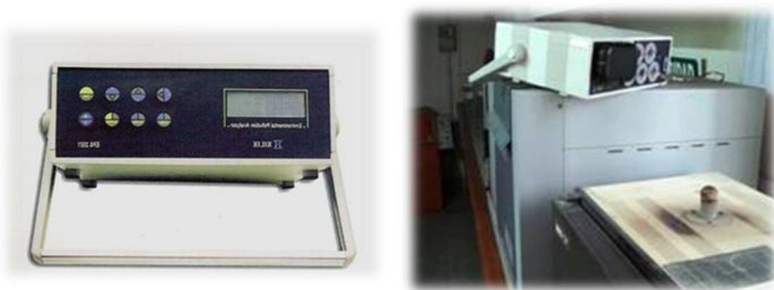
Figura 1. Análisis de gases y PM10 en salida de horno de calcinación.
