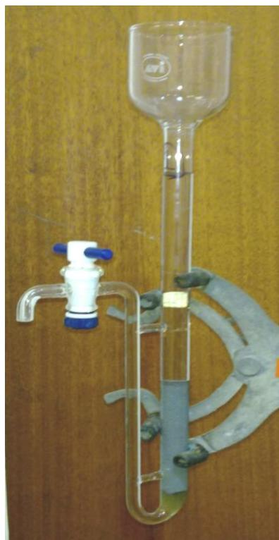
Figura 1: Columna Cd-Cu para reducción de  $\text{NO}_3^-/\text{NO}_2^-$
