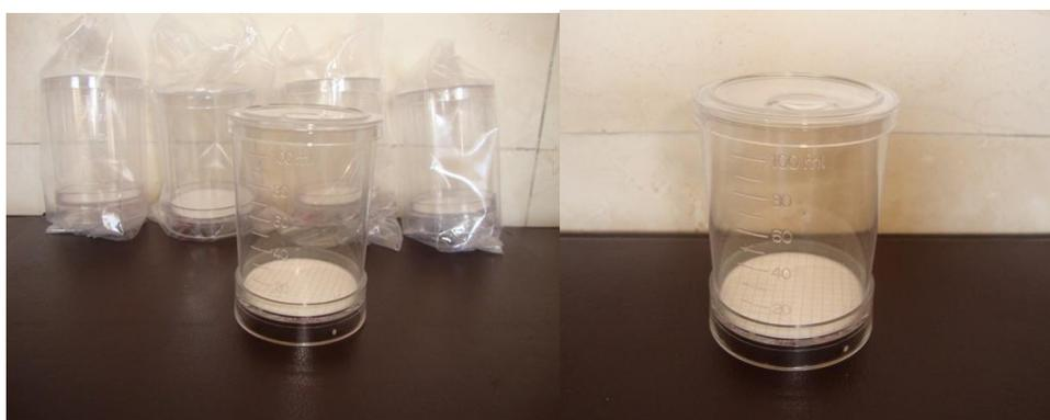
Figura N°:1: Monitores con membrana filtrante estériles para el método de filtración por membrana
