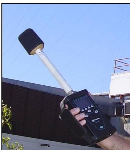
Figura 2: sensor de campo con visualizador portátil.
