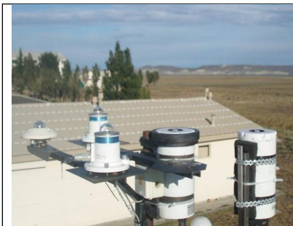
Figura 1. Campaña de calibración de radiómetro GUV 541 de la Estación de Sensado Pasivo del CEILAP en Río Gallegos en Enero de 2011, utilizando el radiómetro GUV 511 de referencia (RGUV).
