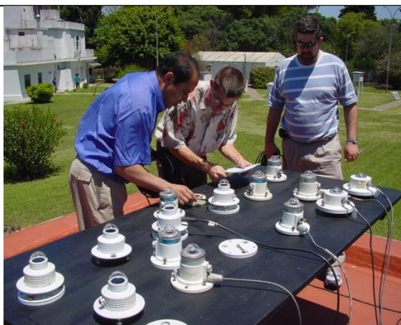
Figura 2. Intercalibración de radiómetros de banda ancha utilizando el patrón secundario viajero de la sede Davos, Suiza, del WMO. La experiencia se realiza cada 4 años en la sede de Villa Ortúzar del SMN.
