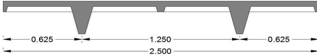
Figura 6-9 | Panel estructural PI en corte
