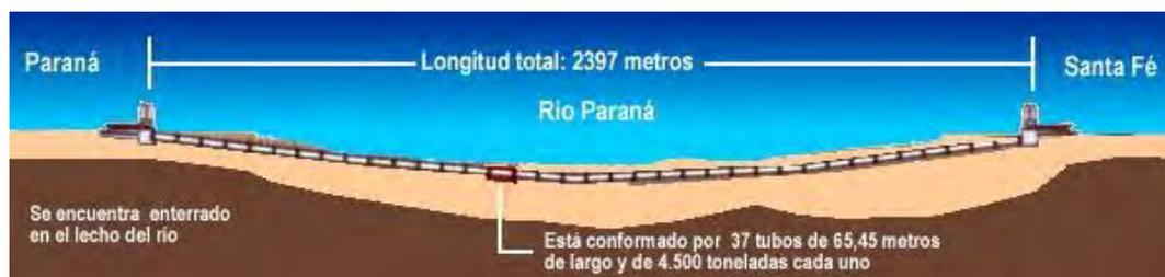
Figura 3-7 | Perfil longitudinal del Túnel
