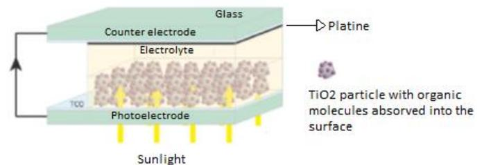
Fig. 2. DSSC Schematic Diagram
