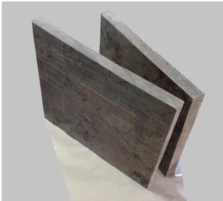
Figura 6. Placas para ensayo de conductividad térmica tipo 300 x 300 x 20 mm
