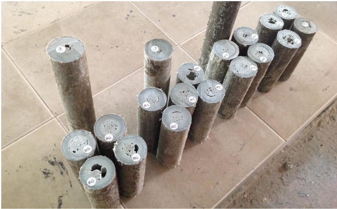
Figura 3. Probetas cilíndricas para ensayos a compresión varias
