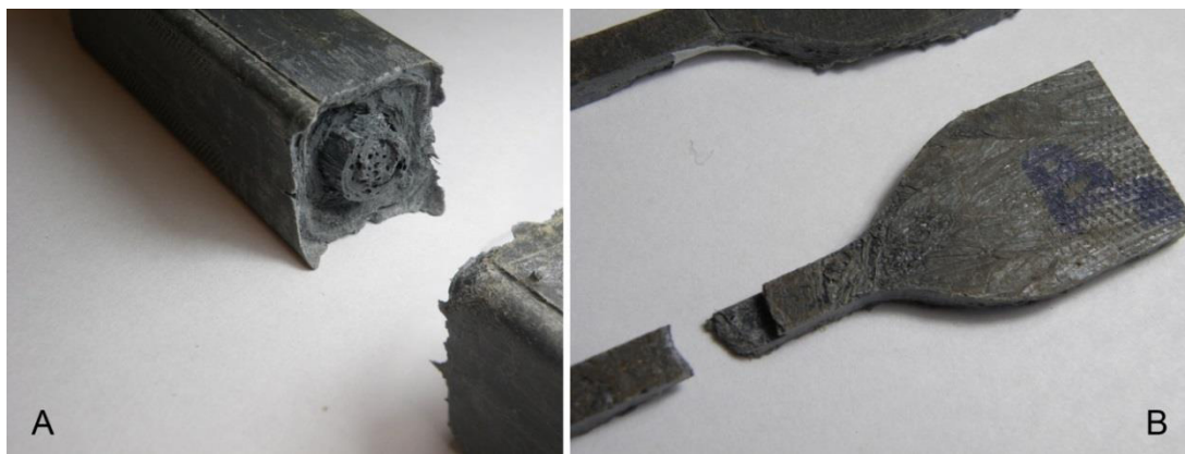
Figura 4. Detalle de probeta ensayos a tracción, barras extruidas de sección cuadrada (A) norma ISO 527-1 (B)
