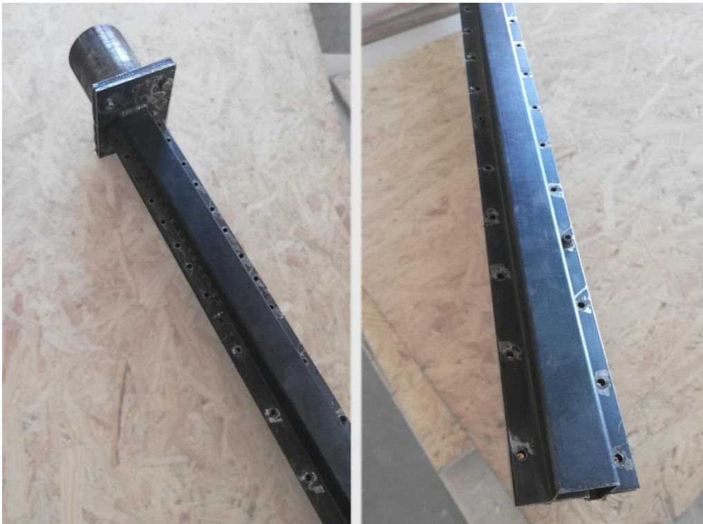
Figura 13. Molde de chapa para extrusión/inyección diseño final (Numero 3)
