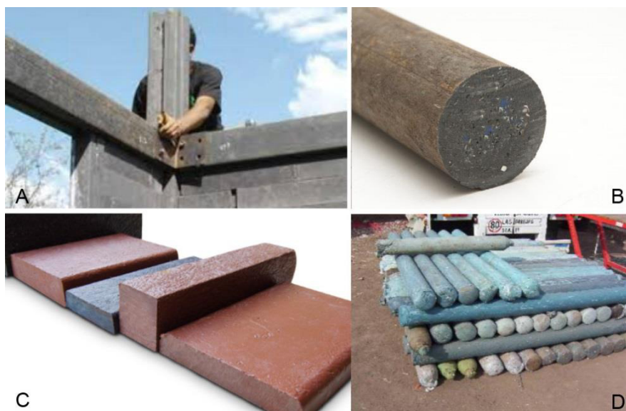
Figura 16. Desarrollos de plásticos mezcla moldeados, Brickarp (A), Timberecco (B,C), EL Vendaval (D).
