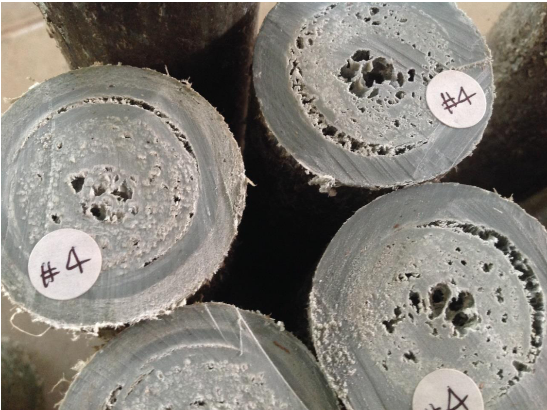
Figura 4. Detalle de probetas cilíndricas para ensayos a compresión varias
