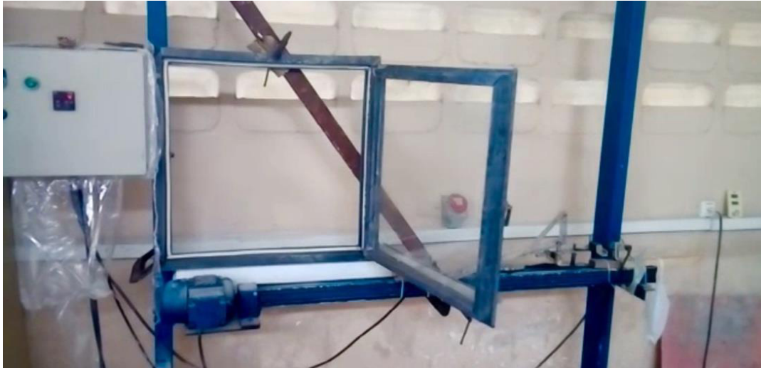
Figura 10. Prototipo del componente de ventana en ensayo de maniobra
