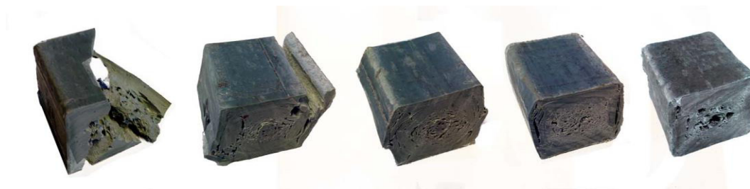
Figura 3. Probetas prismáticas ensayadas de formulación F1 a F5 (izquierda a derecha)
