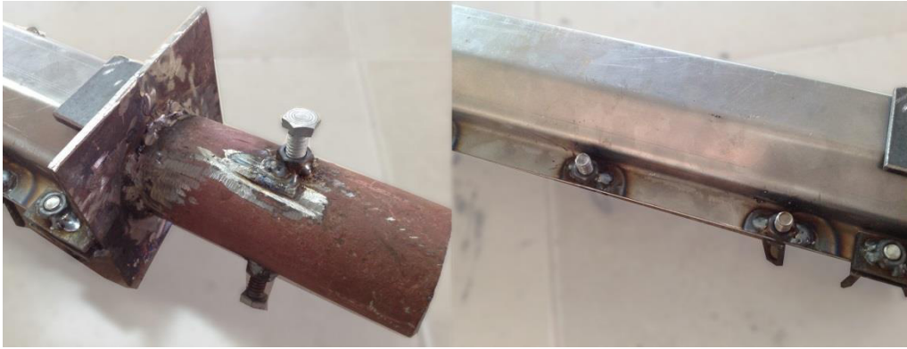
Figura 12. Primer molde de chapa para extrusión/inyección
