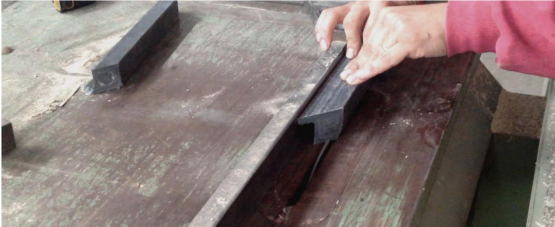
Figura 6. Aserrado longitudinal de perfiles para colocación de vidrio.
