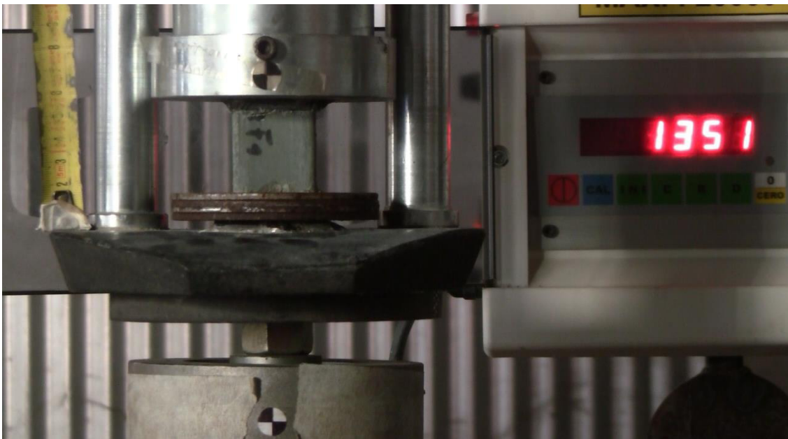
Figura 1. Filmación para análisis de ensayos en prensa universal, compresión en probetas cúbicas
