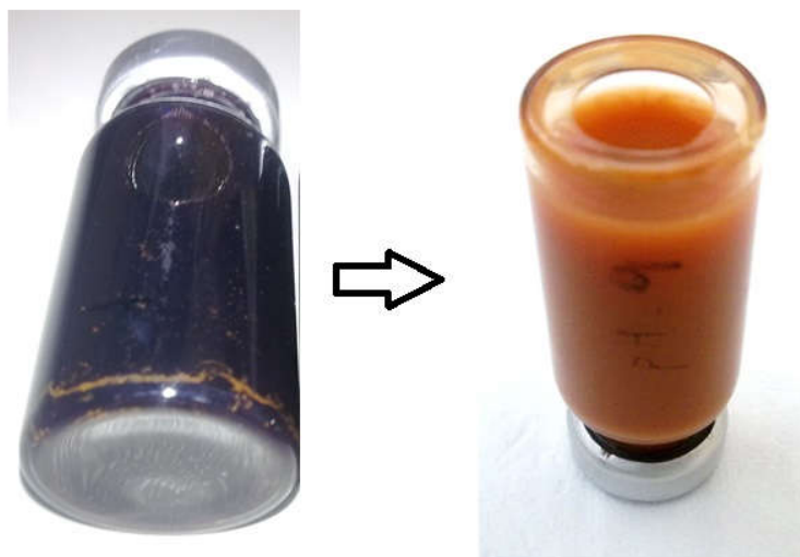
Ilustración 32: Generación de O 2 durante la descomposición del FeO 4 -2 con explosión del vial para liberar presión al final.
