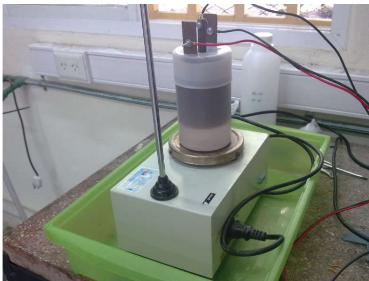
Ilustración 17: Reactor a escala laboratorio antes de comenzar la reacción.
