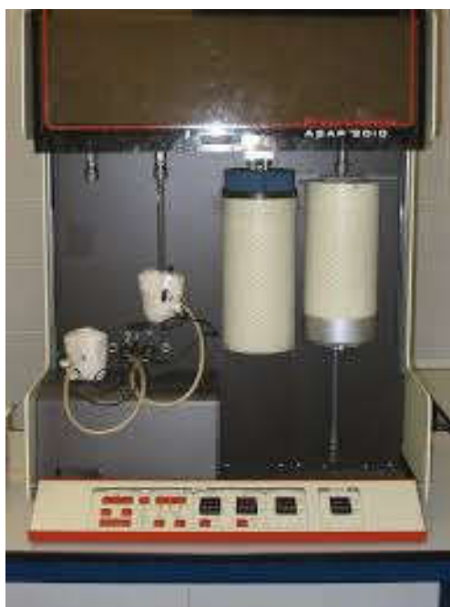
Ilustración 126: Quimisortómetro de gases, modelo ASAP 2000, marca Micromeritics
