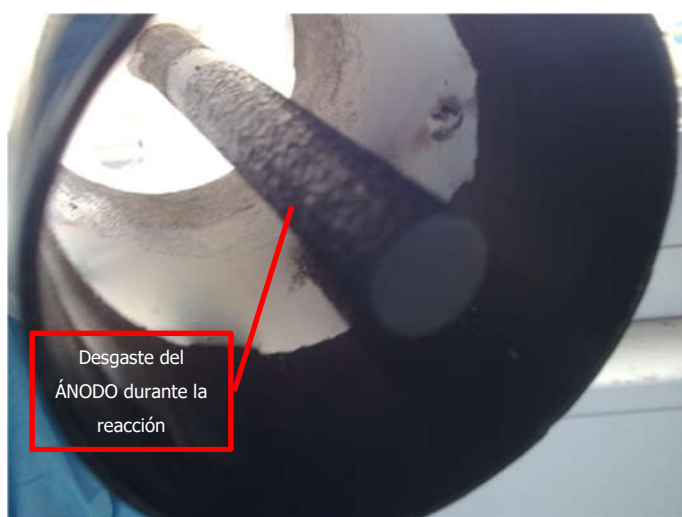
Ilustración 16: Reactor electroquímico construido para el ensayo.
