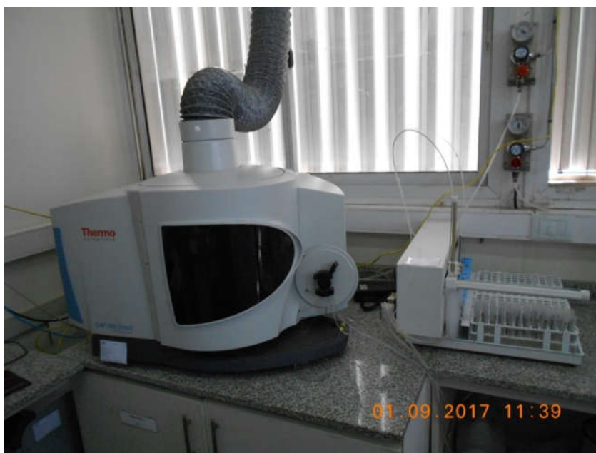
Ilustración 116: ICP-OES, modelo iCAP 7400, marca Thermo Scientific
