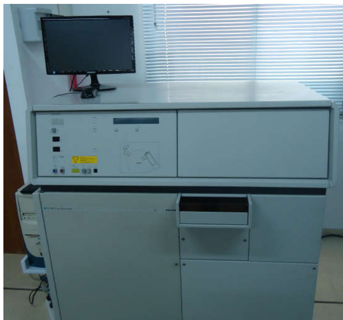
Ilustración 124: Difractómetro, modelo PW1800/10, marca Philips.
