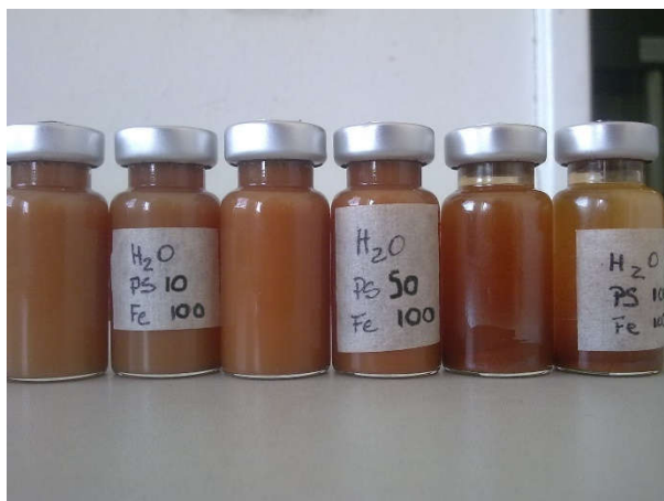
Ilustración 51: Soluciones de trabajo para el análisis de la cupla S_2O_8^{2-}:FeO_4^{2-} al cabo de 3 hs
