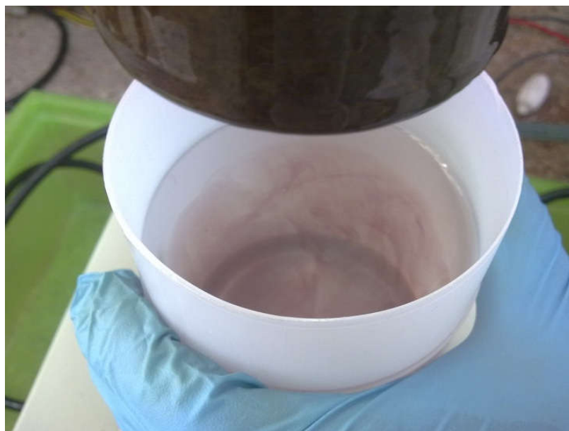
Ilustración 19: Formación de ferrato al inicio de la electrólisis.
