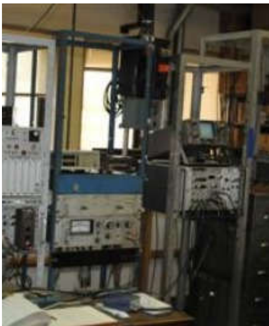
Ilustración 125: Espectrómetro convencional en geometría de transmisión con aceleración constante
