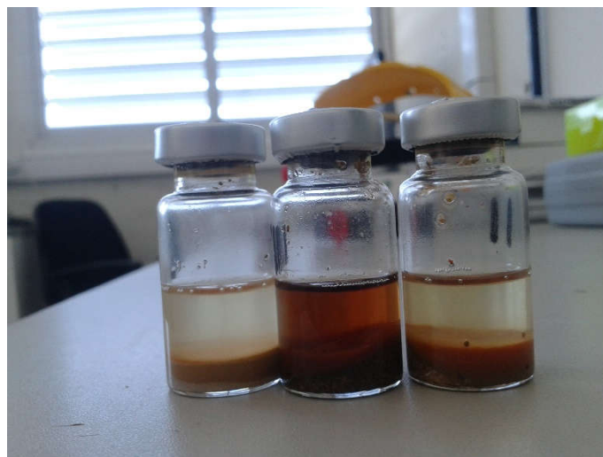
Ilustración 31: Descomposición del K_2FeO_4 en agua con precipitación de Fe(OH)_3
