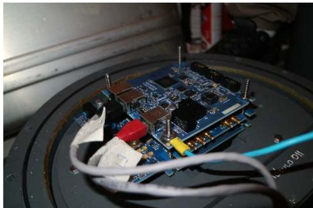
FIGURA 7.4: La fotografía muestra la instalación final de la electrónica del detector, incluyendo a la placa del back-end y el cableado definitivo del módulo.
