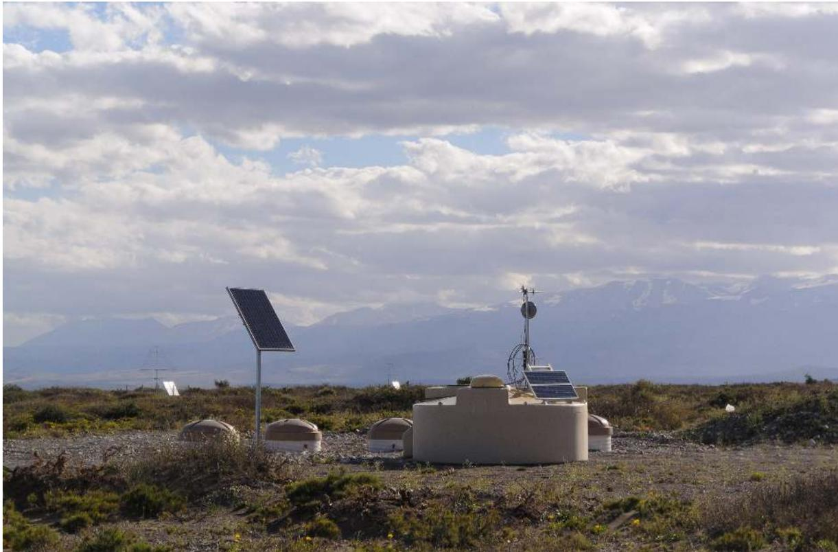
FIGURA 2.11: Fotografía de una típica posición del *Infill* perteneciente al arreglo de ingeniería. En ella, se puede observar el tanque del detector del SD y los cuatro tubos de acceso (diseño de prototipo) de los módulos contadores de muones de esta estación (SD + UMD).
