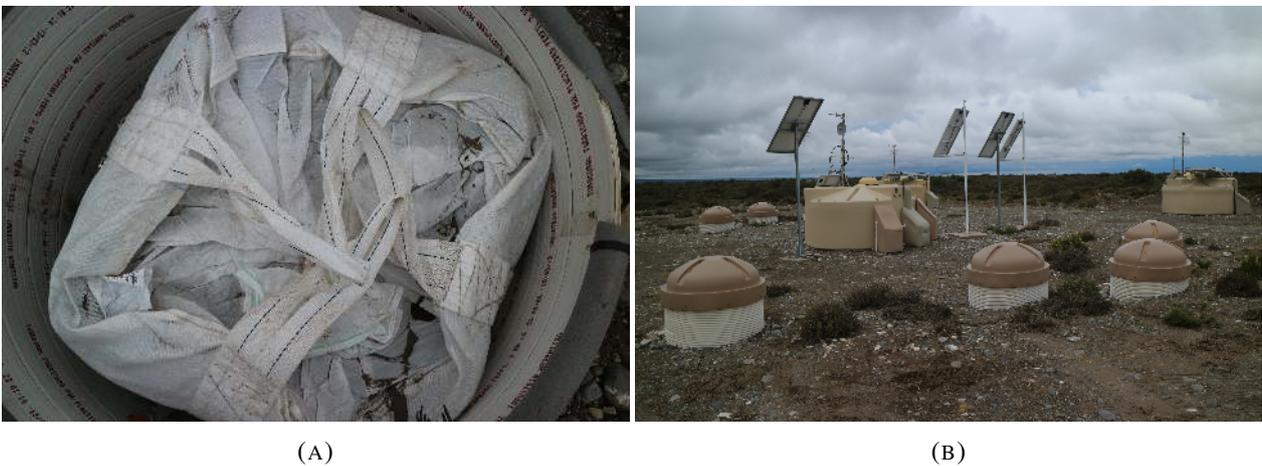
FIGURA 7.6: La fotografía de la izquierda muestra la colocación de las bolsas de tierra para rellenar el tubo de acceso. En la fotografía de la derecha, se pueden observar varios tubos de acceso cerrados con su tapa exterior y, ubicado en el medio entre los tubos de acceso, la estación del SD *Kathy Turner*.
