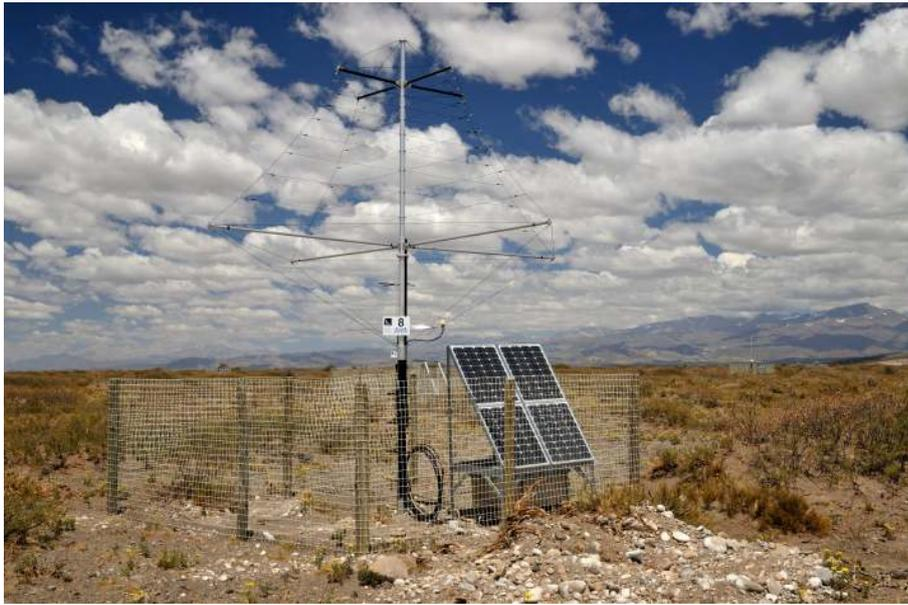
FIGURA 2.8: Fotografía de una estación de AERA instalada en la zona AMIGA-HEAT. Se pueden observar la antena de radiofrecuencia y el panel solar del sistema de batería.
