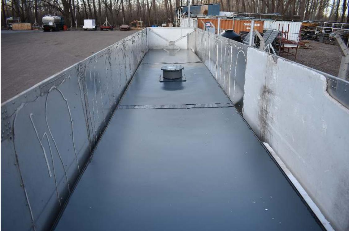
FIGURA 3.4: Fotografía de un módulo de AMIGA terminado dentro del compartimiento para su transporte. Se puede observar el recubrimiento de PVC para hacerlo a prueba de agua.
