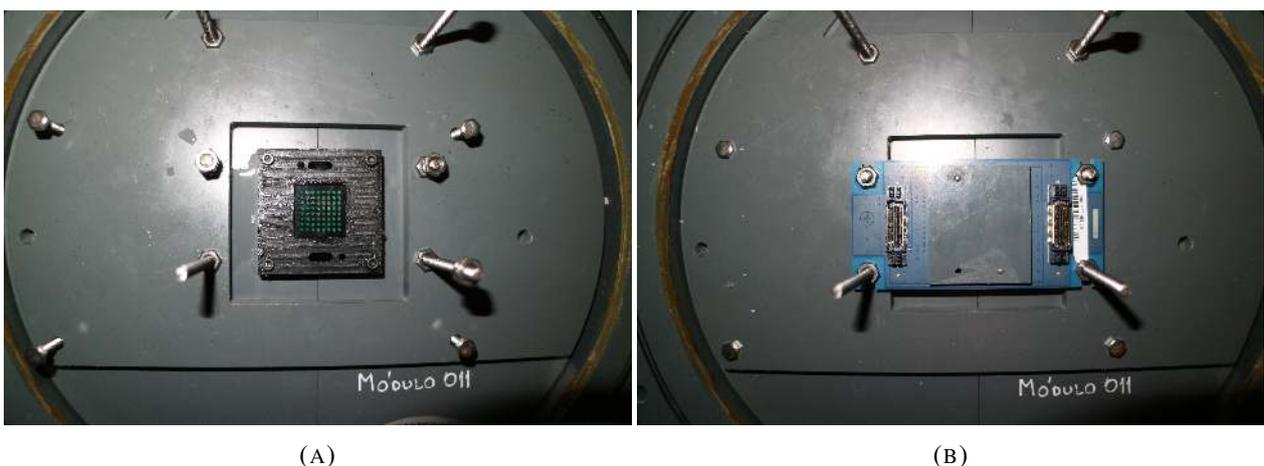
FIGURA 7.2: En la fotografía de la izquierda, se puede observar el adaptador óptico del módulo detector. En la fotografía de la derecha, se muestra la instalación de la placa del SiPM de 64 píxeles en el módulo detector.
