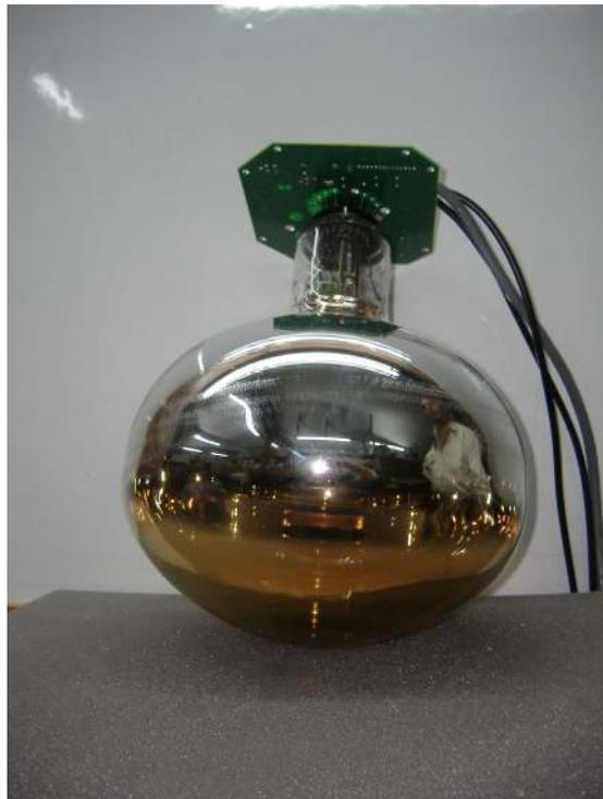
FIGURA 2.3: Imagen del PMT XP1805PA/1 de Photonis utilizado en los detectores de superficie de efecto Cherenkov.
