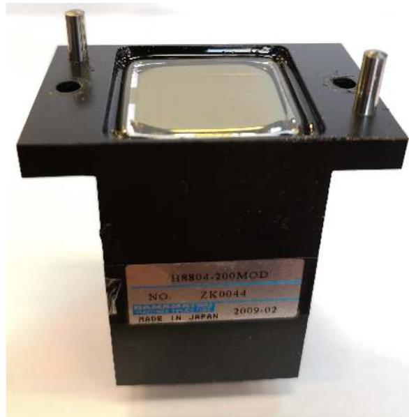
FIGURA 3.6: Fotografía del PMT multiánodo modelo H8804-200MOD utilizado en AMIGA. Las espigas y el encapsulado especial del dispositivo permiten alinear cada una de las fibras del adaptador óptico en centro de sus respectivos píxeles.
