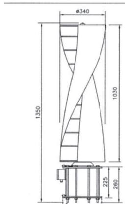
Figura 3 - Modelo de Aerogenerador seleccionado
