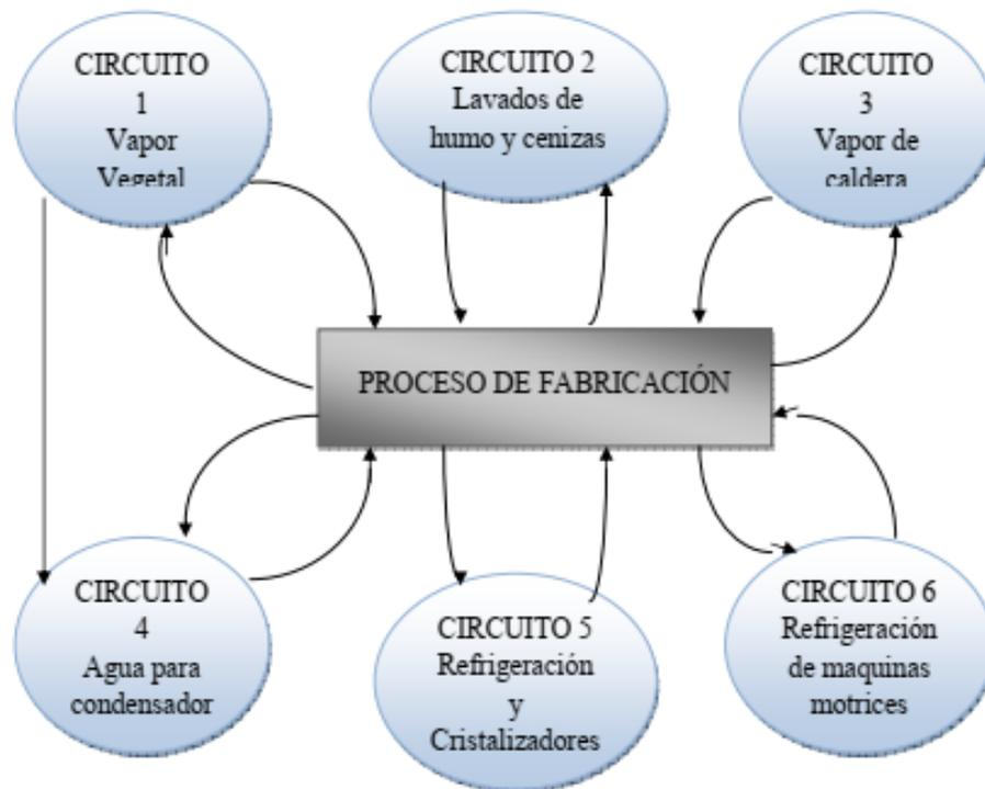
Gráfico N° 10.5.1 – Proceso de fabricación uso del agua
