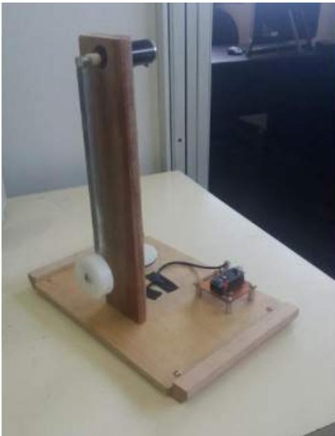
**Fig 3.** Sistema péndulo simple con adquisición Arduino Nano.
