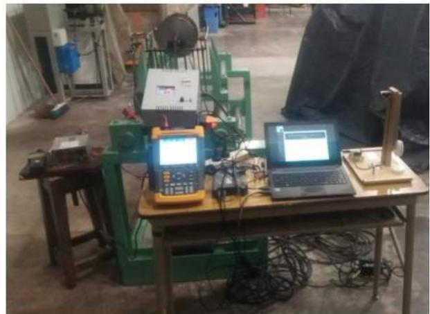
**Fig 2.** Análisis de FFT (Fast Fourier Transform) en un equipo educativo de vibraciones.
