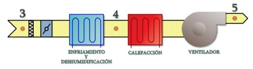
*Figura 15:* Etapas de acondicionamiento de la UTA por refrigeración mecánica.
