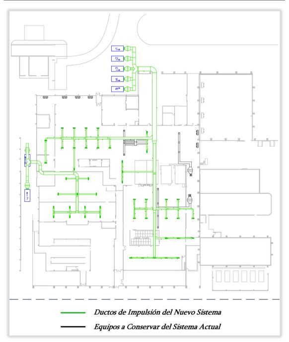
Figura 13: Trazado esquemático de los ductos de impulsión para TyE y EyC.
