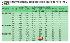
Figura 36: Potencia disipada por bloque diferencial.
