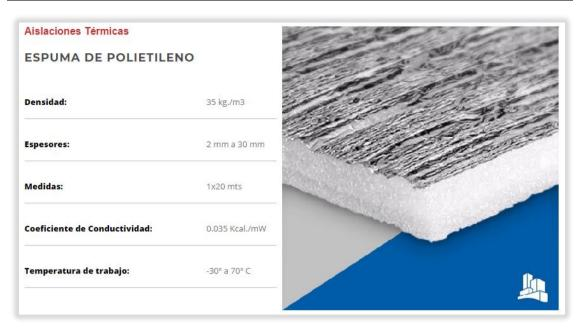
Figura 11: Espuma de polietileno con foil de aluminio.
