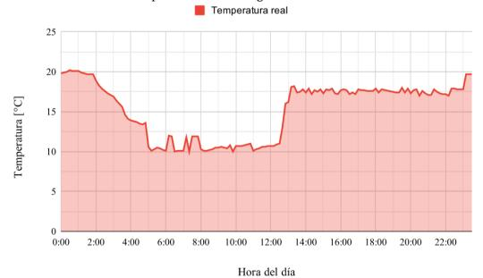
*Figura 6:* Evolución de temperaturas en sala de TyE a lo largo de un día. Medición del día 16/02/18.
