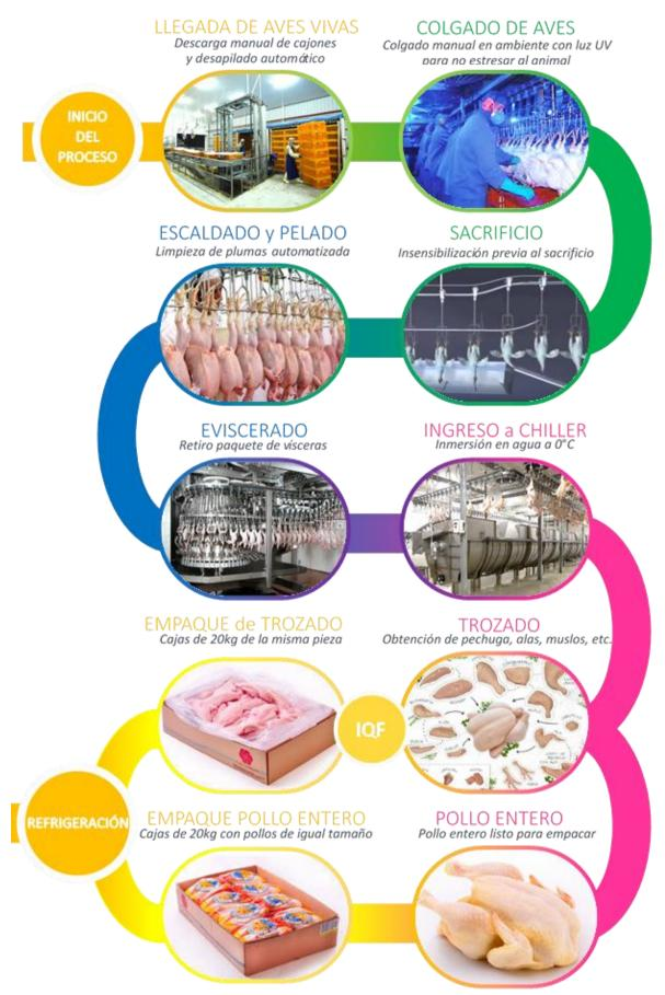
Figura 4: Diagrama de procesos en la planta de faena avícola
