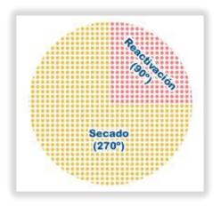
*Figura 12:* Porciones del rotor por las que pasa el aire de proceso (270°) y de reactivación (90°).
