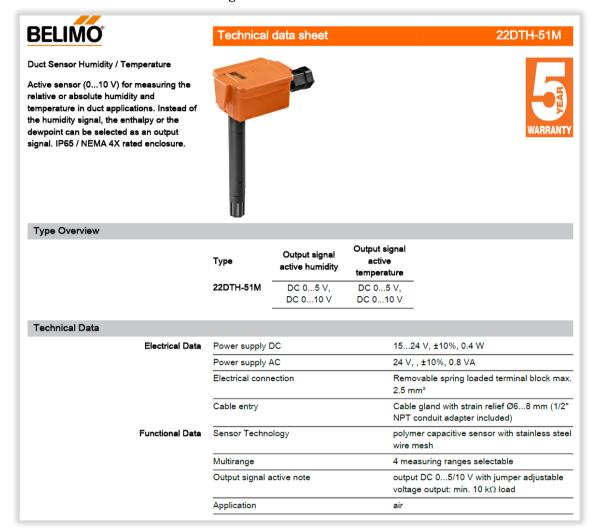
Figura 13: Sensor combinado T/HR.
