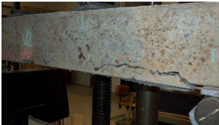
Figura 6. Modo de falla de viga reparada: desprendimiento del recubrimiento de hormigón
