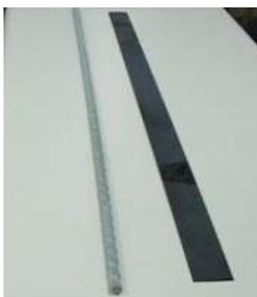
Figura 2. Láminas de PRFC y barras de fibra de vidrio
