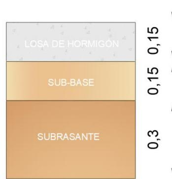
Figura 6-5 - Composición del paquete estructural. Fuente: propia.
