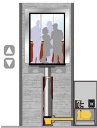
Figura 8-23 - Esquema de ascensor hidráulico. Fuente: [www.google.com.ar](http://www.google.com.ar).
