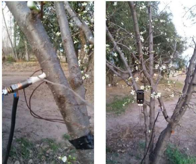
Fig. 1. A la izquierda, la bujía de calentamiento, a la derecha datalogger
