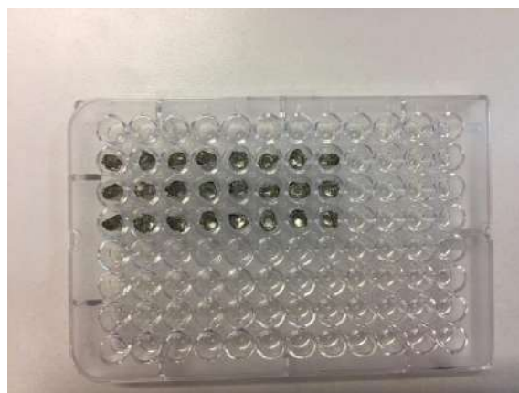
Fig 2. Las muestras se colocan en cápsulas de estaño para ser introducidas al espectrómetro
