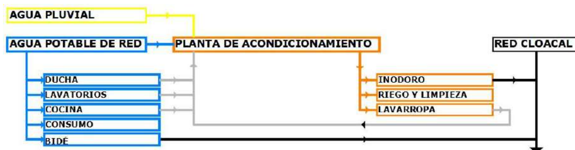
Fig. 1. Esquema de funcionamiento de sistema de acondicionamiento
