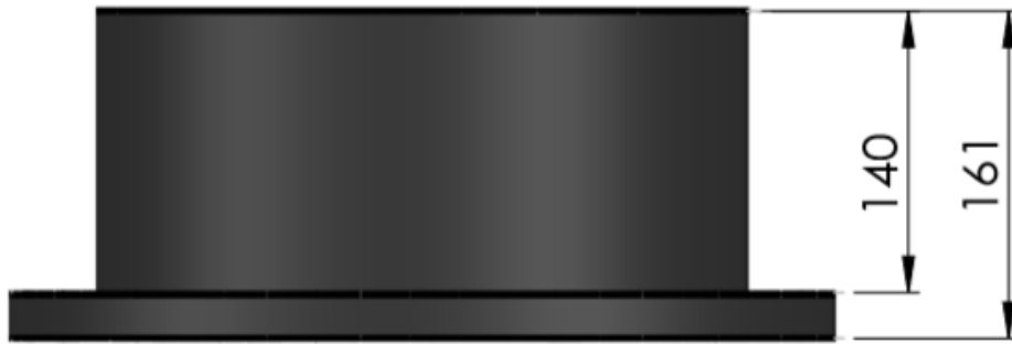
Figura N°4.17: Vista lateral de acople.
