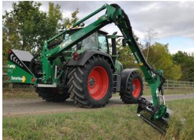
Figura N°2.2: Desmalezadora de alcance, simple.
