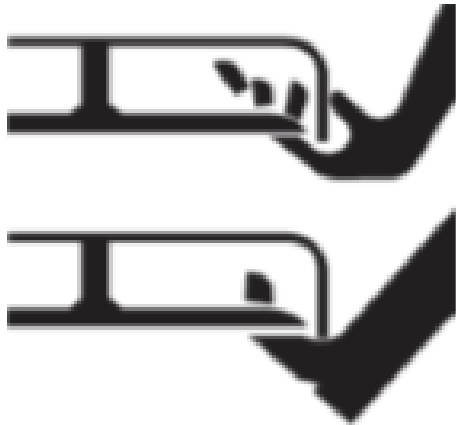
Fig. N°8.9: Accidente típico, como consecuencia de meter manos y pies, cuando la máquina se encuentra funcionando.
