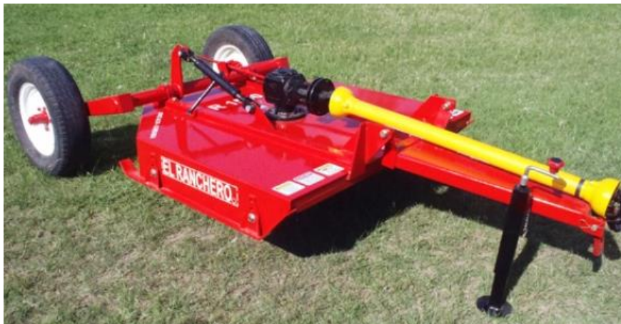
Figura N°2.1: Desmalezadora de arrastre.
