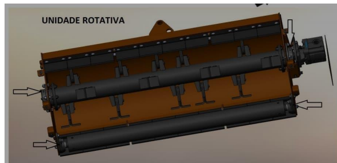
Figura N° 2.3: Rotor de desmalezadora de alcance simple, de la marca Rocadeira.
