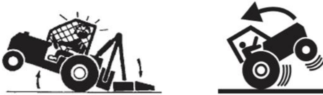
Figura N°8.8: Vuelco del tractor, como consecuencia de no tomar medidas para compensar el hecho de que el peso de la máquina no coincida con el CG del tractor.
