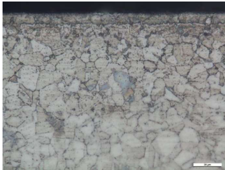
Figura 1. Microestructura, espesor de capa 4µm.
