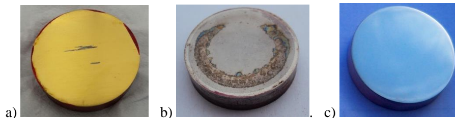
Figura 2. Fotos posterior al ensayo de niebla salina de muestras: a) D; b) N; c) P
